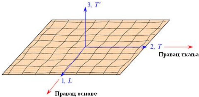
Слика 6.1: Ортотропни слој ламината ојачан фабричком тканином
