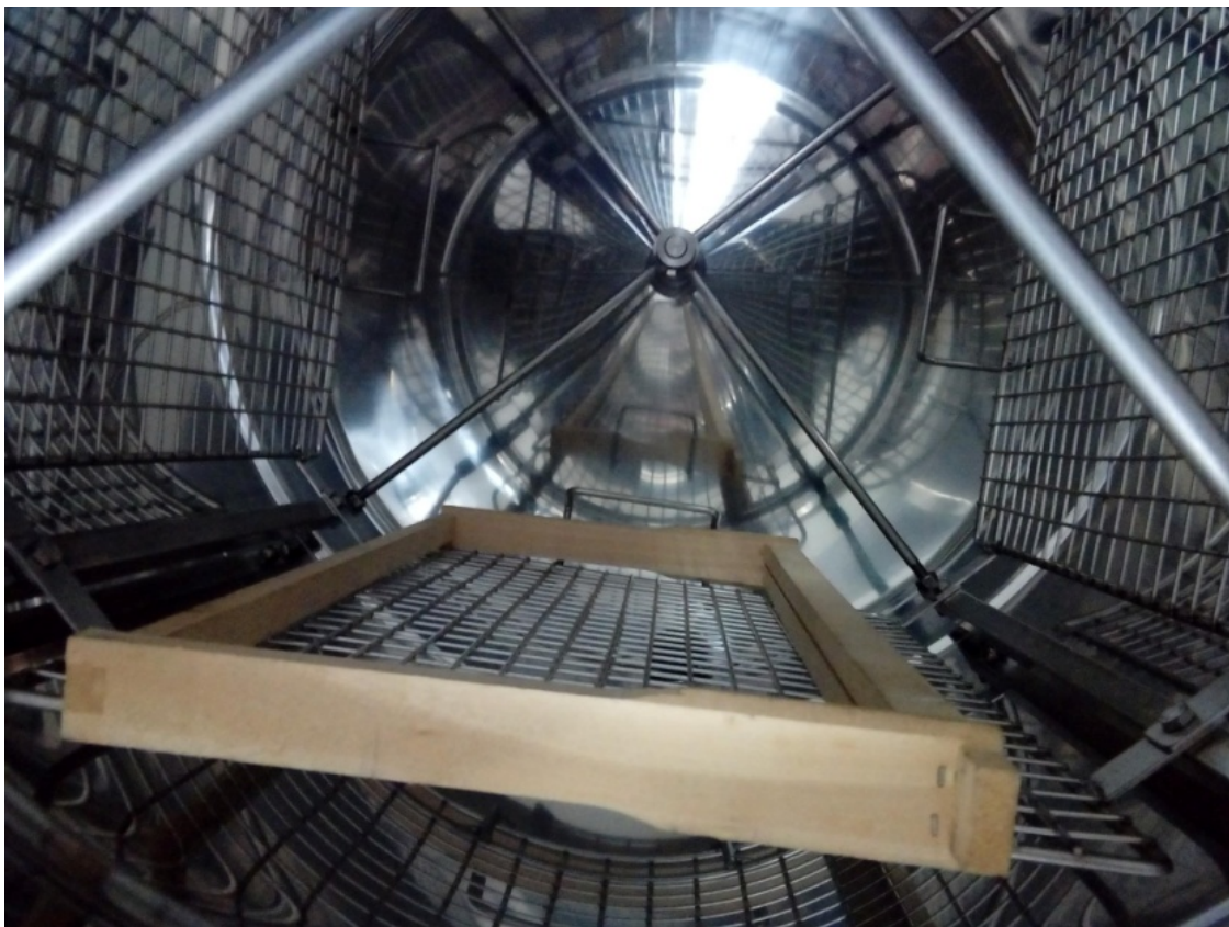
Слика 3.7 Пример центрифуге без средње осовине [7]
