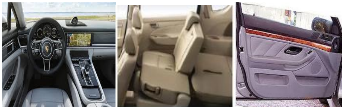
Слика 2.9 Примена полиуретана у ентеријеру аутомобила
