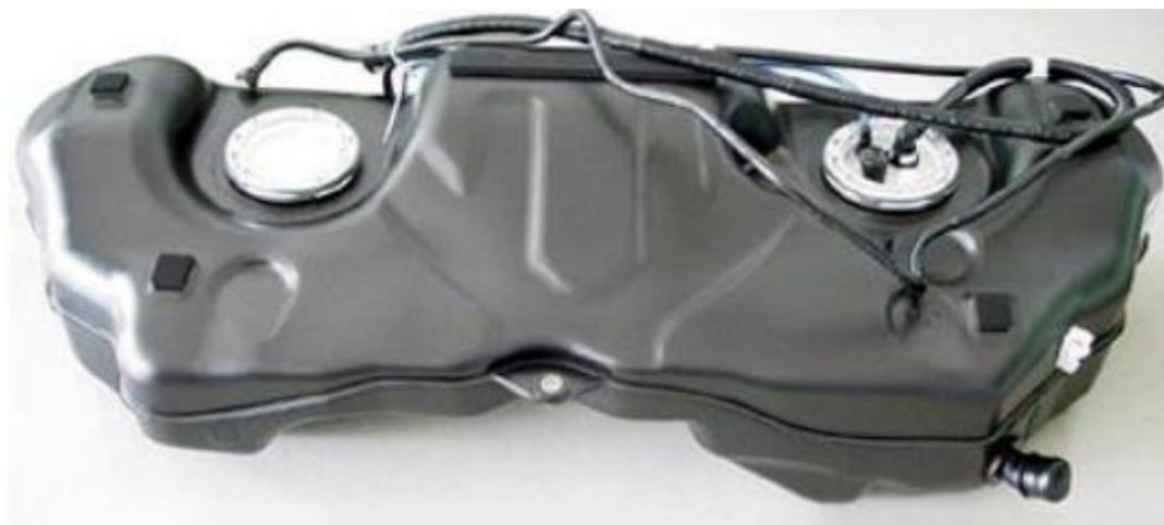
Слика 2.7 Резервоар за гориво од пластике [5]
