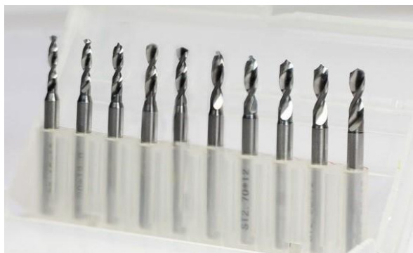
Слика 4.6 Алат за обраду пластике бушењем [13]
