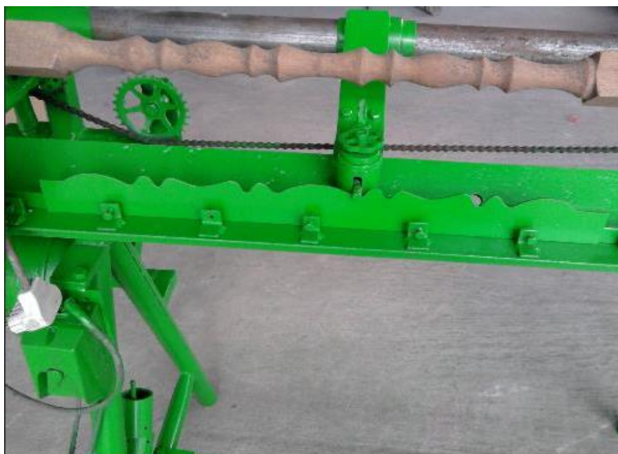
Слика 22-Крута веза алата и шаблона код копирне обраде дрвета [6]
