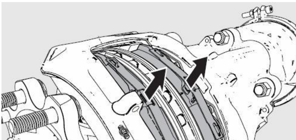
Слика 9.7. Поступак замене кочних плочица [21]
