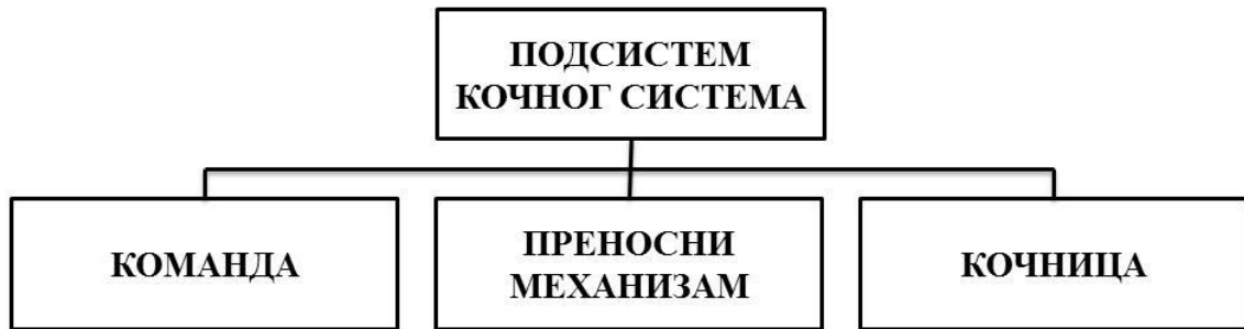
Слика 2.2. Подсистеми кочног система [5]
