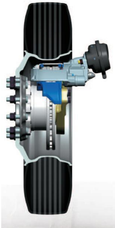
Слика 1.9. Крајњи изглед пнеуматичких диск кочнице на точку [4]
