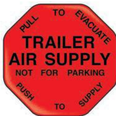
Слика 8.19. Дугме вентила за снабдевање приколице [17]
