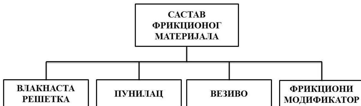
Слика 6.1. Састав фрикционог материјала [5]
