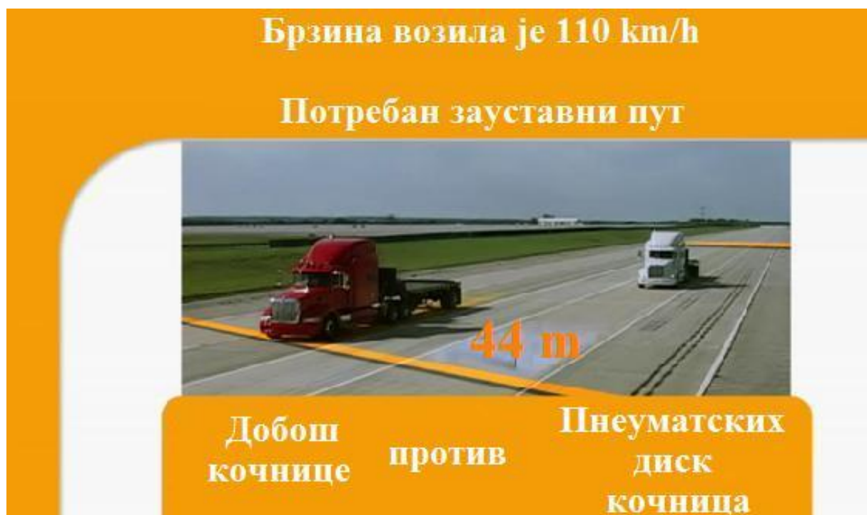
Слика 7.2. Добош кочнице против пнеуматичких диск кочница [16]
