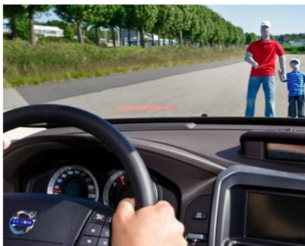
Слика 35 - Volvo Pedestrian Safety System даје упозорење возачу о судару [10]
