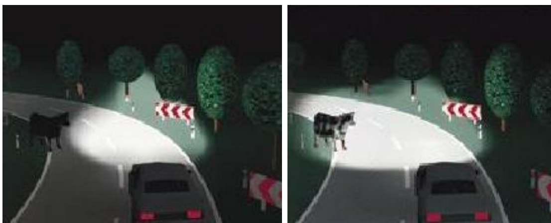
Слика 38 - Разлика између класичног и напредног осветљавања пута [14]
