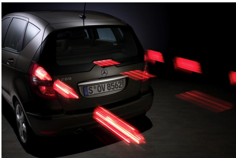
Слика 37 - Рад адаптивних светала кочница [13]
