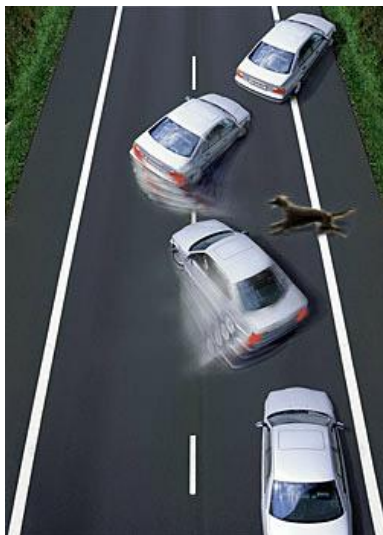
Слика 7 – Понашање возила при нагом кочењу без ABS-а (а) и са ABS-ом (б) [3]
