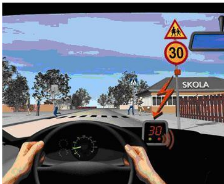
Слика 34 - ISA даје звучно упозорење возачу да смањи брзину [8]
