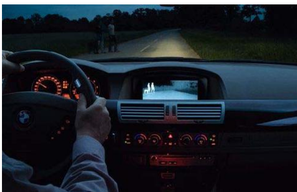
Слика 14 - Слика добијена инфрацрвеним снимањем на дисплеју у возилу [2]
