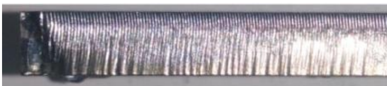
Слика 5.1. Различита топографија површине на улазном (горњем) и излазном (дољем) делу узорка 25
