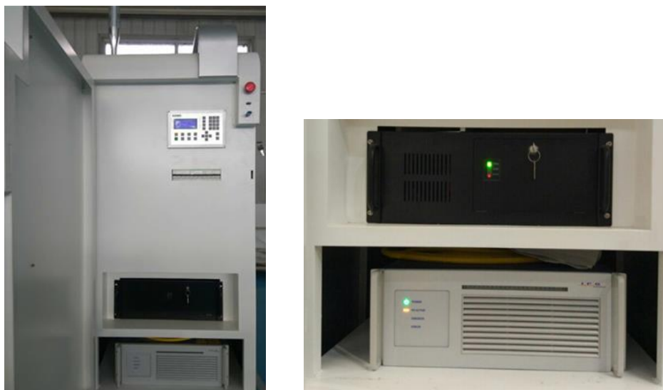
Слика 3.8. Положај ласерског извора у контролној кабини [14]
