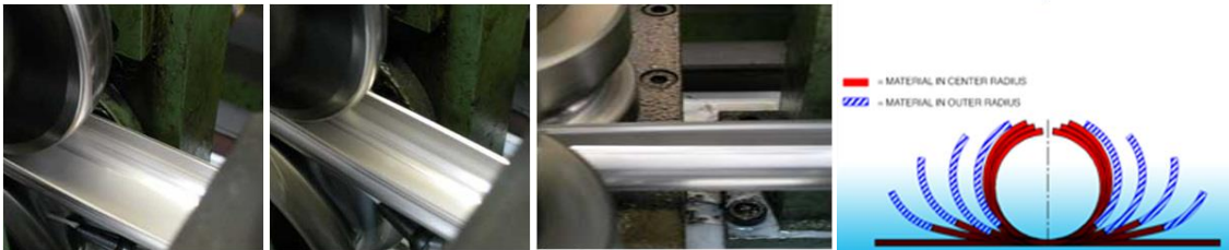
Слика 2 - Профилисање цеви
