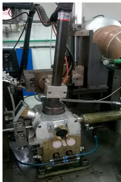
Слика 6 - Welding box за ТИГ заваривање у Elit Inox-у
