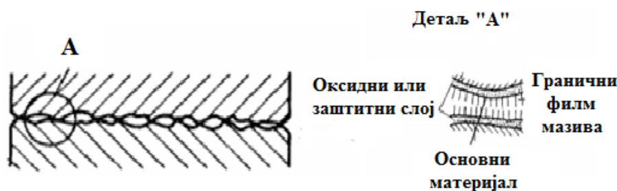
Слика 10. Приказ граничног подмазивања
