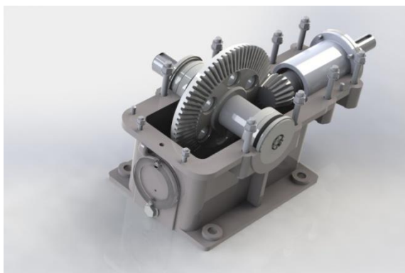
Слика 18. Редуктор чије се осе вратила секу
