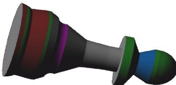
Слика 111. Приказ предмета обраде након одрађене сложене контуре
