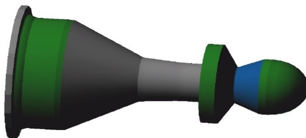
Слика 105. Приказ одрађене контуре предмета обраде
