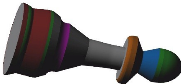
Слика 114. Приказ предмета обраде након одрађеног радијуса
