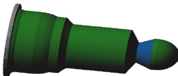
Слика 102. Приказ одрађеног конуса на предмету обраде
