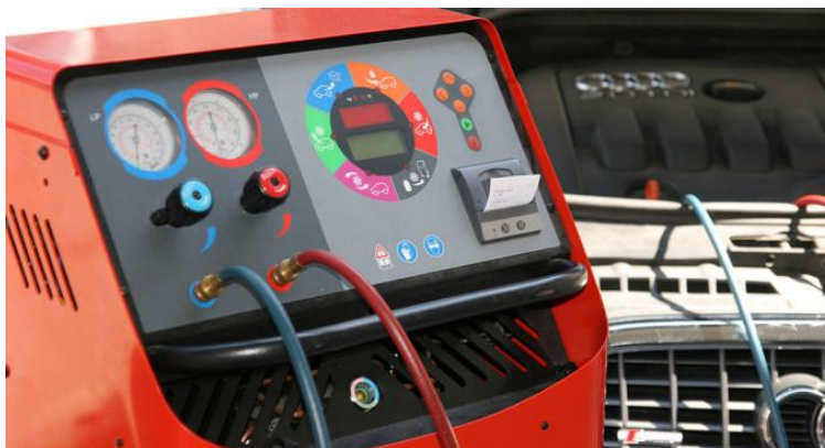
Слика 5 – Уређај за испитивање количине и квалитета расхладне течности на возилу [12]
