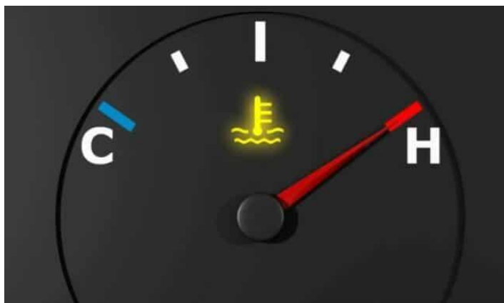
Слика 3 – Светлосни сензор и казаљка који приказују појаву прегревања мотора [10]
