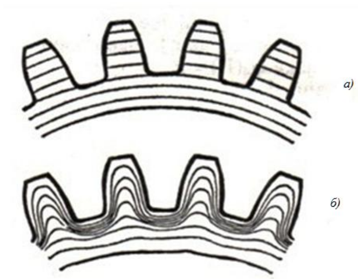
Слика 3.8 Облик и ток влакана материјала у области зубаца зупчаника при њиховој изради резањем (а) и ваљањем (б)
