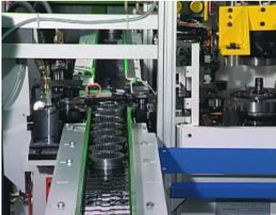
Слика 3.21 Савремена машина за ваљање зубаца зупчаника у хладном стању, од произвођача Escofier Technologie S.A. ALS CNC [9]
