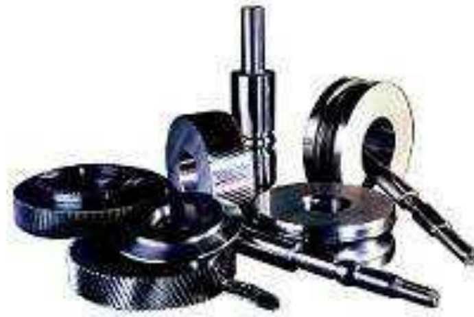
Слика 3.19 Алати за савремене машине за ваљање зубаца зупчаника у хладном стању, од произвођача Escofier Technologie S.A.
