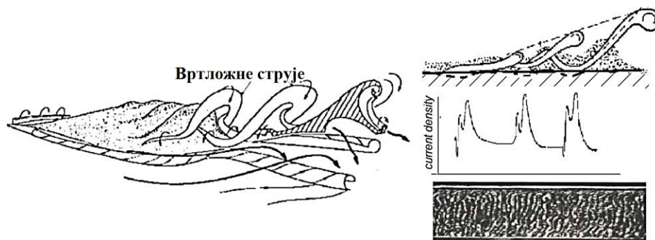
Слика 2.24. Илустрација настанка вртложних струја током турбулентног струјања електролита (лево) и дијаграм густине електричне струје током турбулентног струјања електролита и изглед обрађене површине предмета обраде услед вртложних струја (десно) [8]
