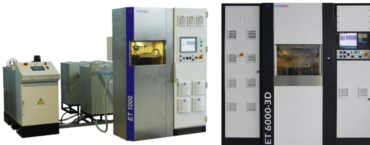
Слика 3.23. Савремене вертикалне машине за процес тродимензионалне електрохемијске обраде „Indec: ECM ET1000“ (лево) и Indec: ECM ET6000-3D (десно) [35]
