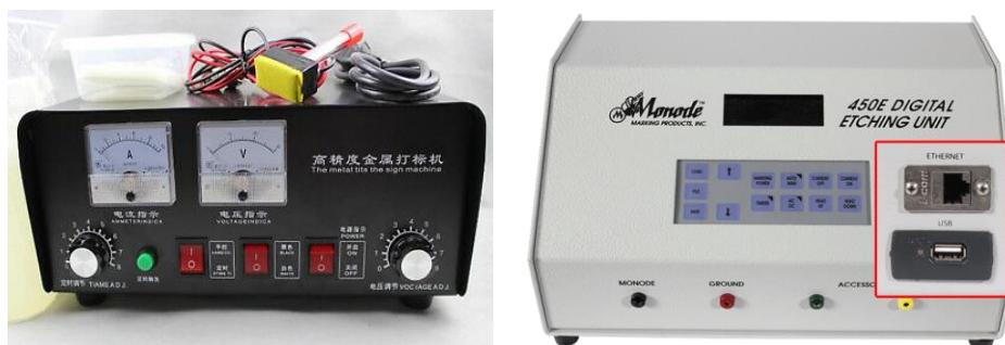
Слика 5.6. Извор (јединица) напајања са уграђеним амперметром и волтметром [45, 46]
