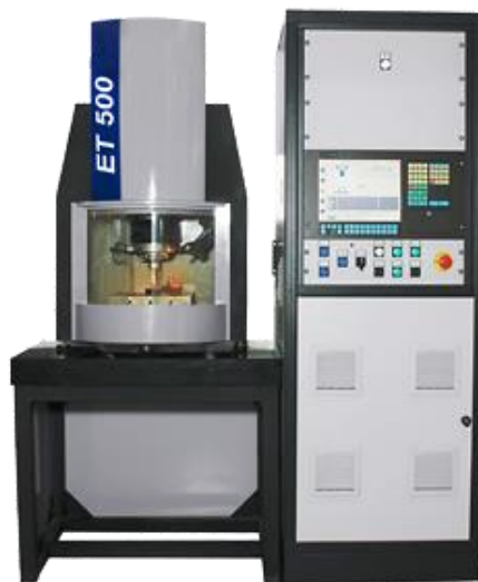
Слика 3.25. Савремена вертикална стона машина за електрохемијску обраду „Indec: ECM ET500“ [35]
