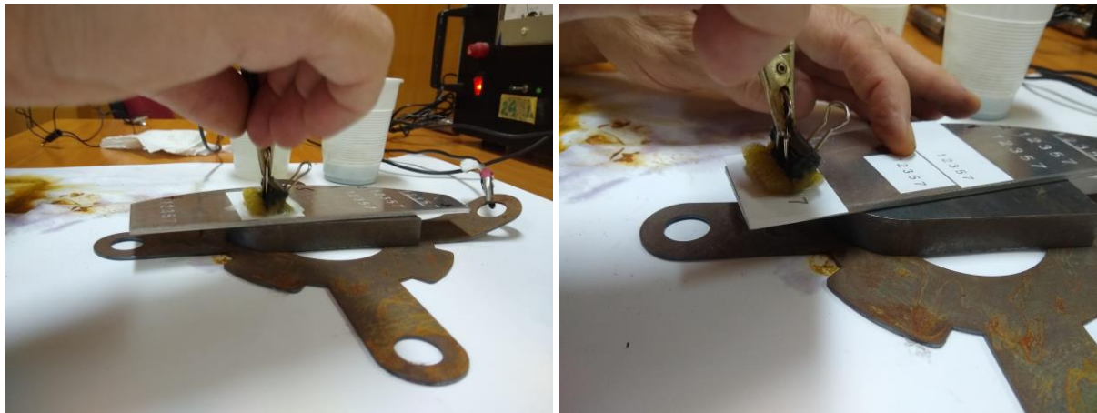
Слика 5.35. Поступак електрохемијског означавања узорка од алуминијума
