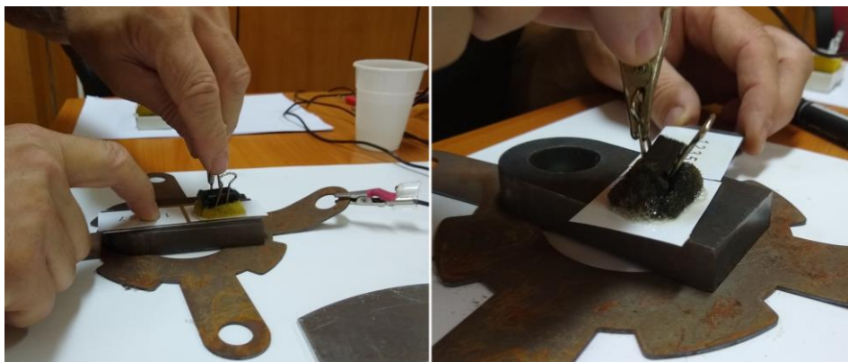
Слика 5.32. Поступак електрохемијског означавања узорак
