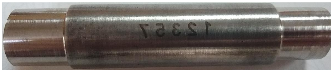
Слика 5.41. Цилиндрични узорак од термички обрађеног челика
