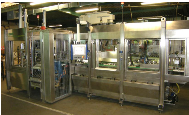
Слика 3.27. Савремена вертикална специјална машина са више радних станица за процесе електрохемијске димензионалне обраде [36]
