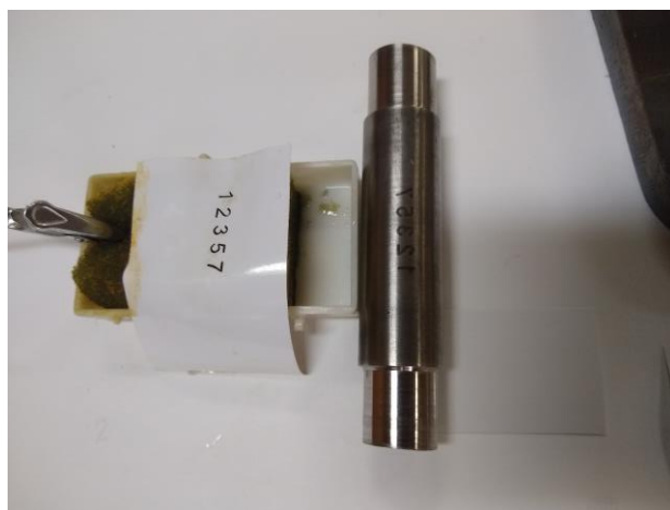
Слика 5.34. Поступак електрохемијског означавања цилиндричног узорка
