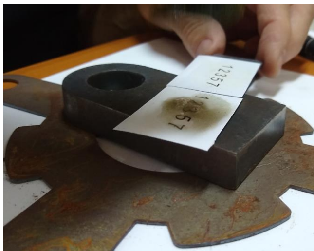
Слика 5.33. Остатак електролита који се брише са шаблона и узорка након поступка електрохемијског означавања
