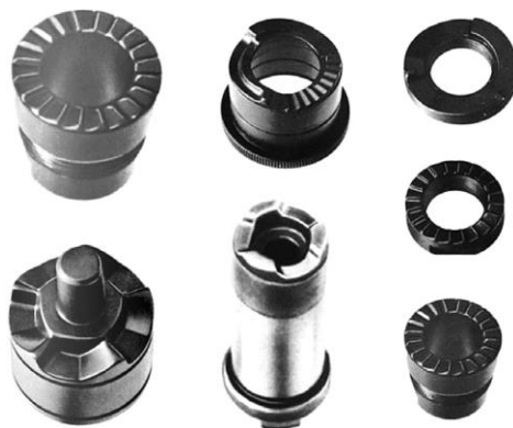
Слика 4.3. Примери делова за електричне алата израђени електрохемијском обрадом [2]
