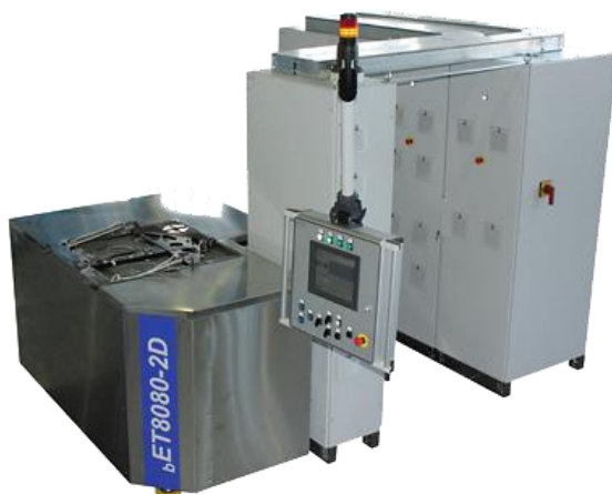
Слика 3.20. Савремена хоризонтална машина за процес дводимензионалне електрохемијске обраде „Indec: ECM ET8080-2D“ [35]
