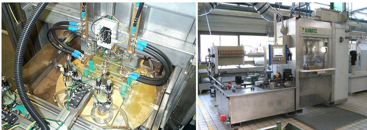
Слика 3.28. Савремена машина за електрохемијску обраду са обртним столом [35]
