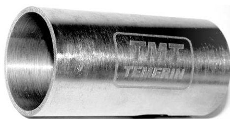
Слика 4.4. Пример чауре на којој је угравиран знак фирме [2]
