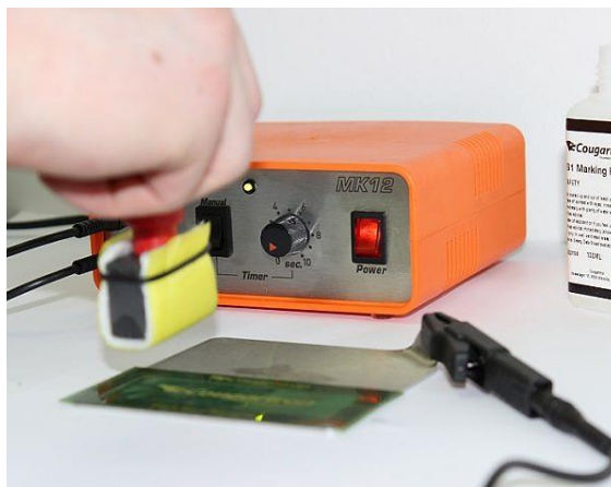
Слика 5.19. Уређај са опремом за електрохемијско означавање [37]
