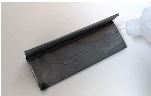
Слика 5.22. Наношење електролита на површину предмета обраде [37]
