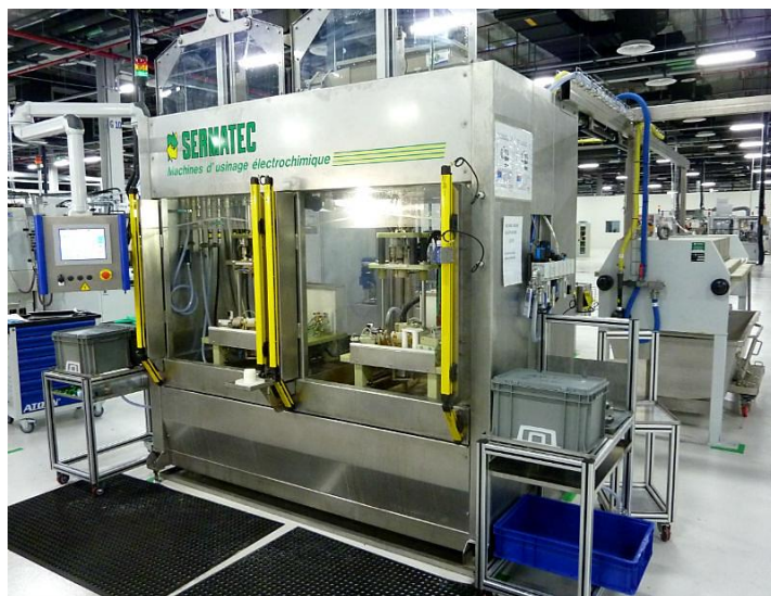
Слика 3.26. Савремена вертикална машина за електрохемијску димензионалну обраду са два носача електрода [36]
