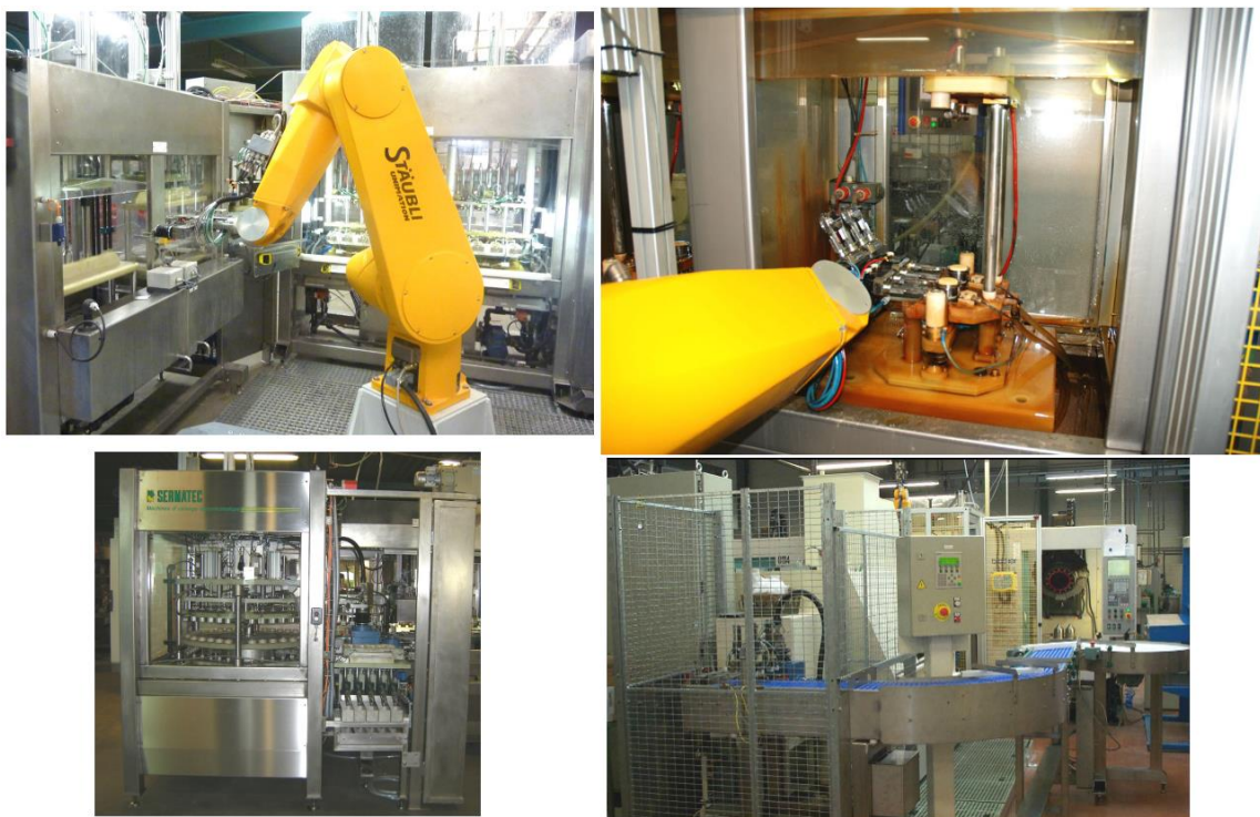
Слика 3.31. Разна додатна опрема која се уграђује у постројења за електрохемијску обраду: робот, односно манипулатор, радна станица за испирање и деконтаминацију предмета обраде и покретна трака за транспорт предмета обраде [36]
