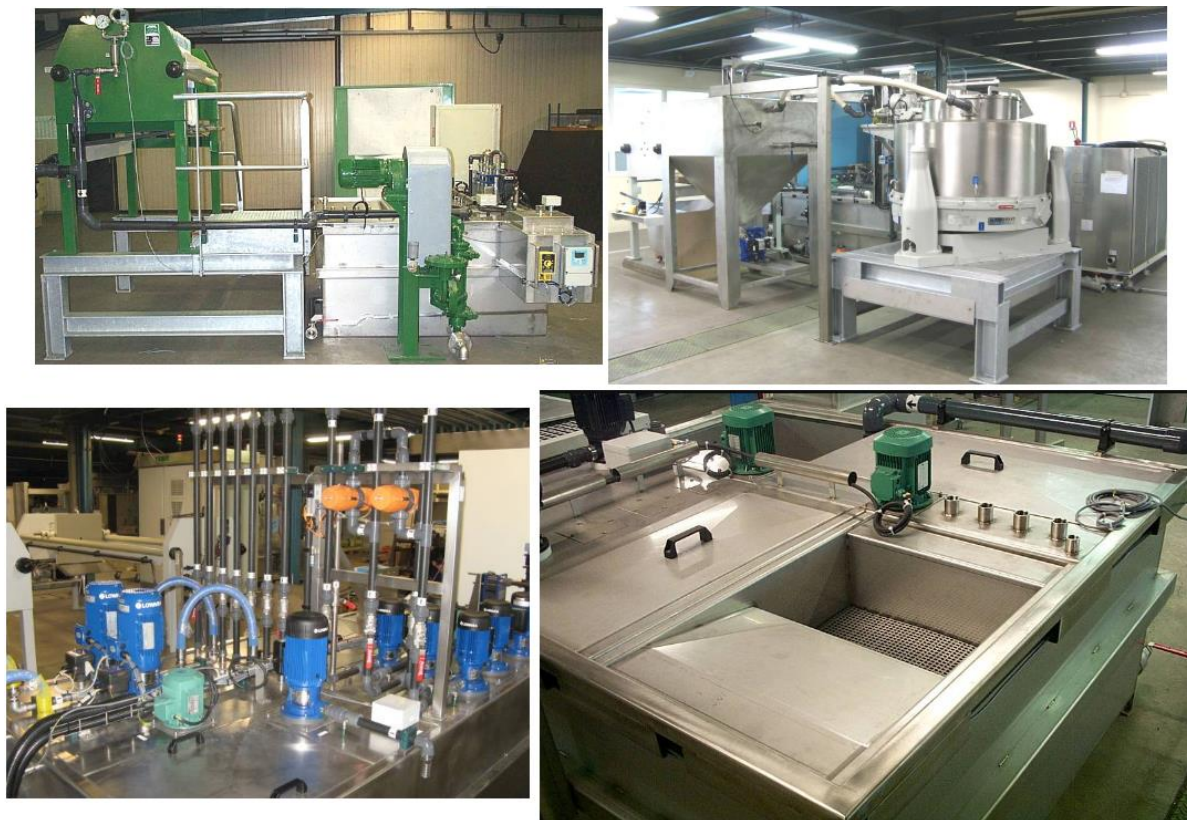
Слика 3.29. Систем и агрегат за пречишћавање, циркулацију и регенерацију електролита [36]
