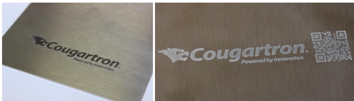
Слика 5.26. Електрохемијско означавање наизменичном струјом (лево) и једносмерном струјом (десно) [37]
