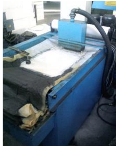
Слика 4.10 Приказ система за хлађење и подмазивање [7]
