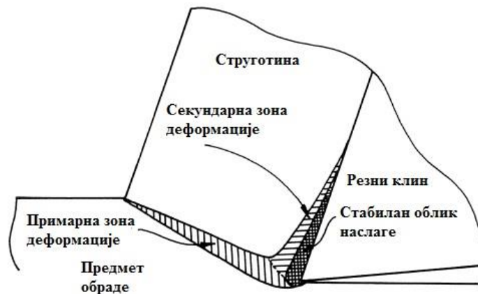
Слика 2.6 Стабилан облик насlage на резном клину
