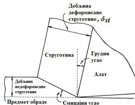
Слика 2.8 Параметри ортогоналног резања метала
