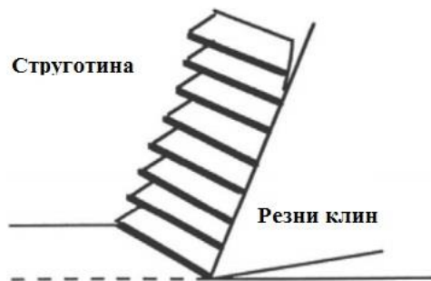
Слика 3.26 Ламеларни тип струготине [4].
