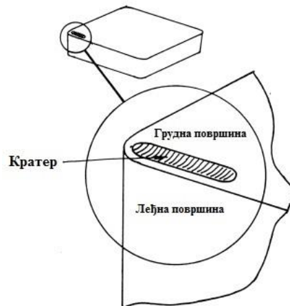
Слика 3.15 Кратер настао услед хабања на грудној површини [5]
