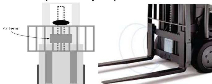
Слика 26. Положај антене на виљушкар и конкретан пример антене на виљушкар
