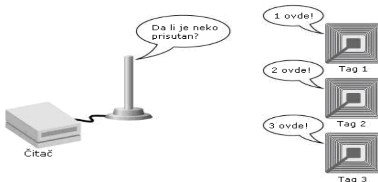
Слика 8. Начин на који таг обавештава читач о свом присуству
