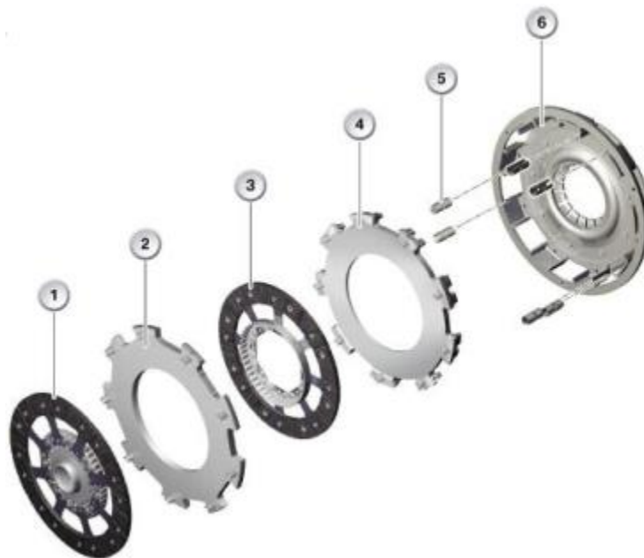
Слика 4.37. Двострука спојница са сувим фрикционим површинама код возила BMW E60 M5 : 1. фрикциони диск 1, 2. централна (средишња) плоча, 3. фрикциони диск 2, 4. контактна плоча, 5. опруга, 6. потисна плоча [19]
