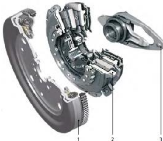
Слика 3.2. Систем за пренос снаге код возила са двоструком спојницом: 1. двоструки замајац, 2. двострука спојница, 3. механизам за повезивање и укључивање вратила [8]
