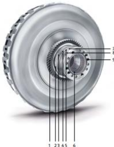
Слика 3.12. Двострука спојница са мокрым фрикционим површинама, страна окренута ка мењачу: 1. погонски зупчаник уљне пумпе, 2. радијални заптивач за прикључак сета K_1 , 3. ротациони прикључак сета K_1 , 4. радијални заптивач за прикључак сета K_1 , 5. радијални заптивач за прикључак сета K_2 , 6. ваљкасти лежај улазне осовине, 7. ротациони прикључак сета K_2 , 8. радијални заптивач за прикључак сета K_2 , 9. отвор за хлађење уљем [8]
