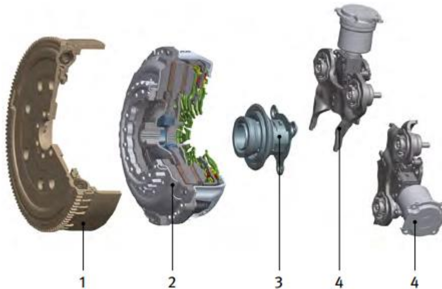
Слика 4.3. Двострука спојница са сувим фрикционим површинама (Ford DPS6, Hyundai-Kia D6GF1, Renault DC0/DC4 и Smart H-DCT): 1. замајац са двоструком масом, 2. двострука спојница, 3. водећа чаура са причврсним лежајем, 4. покретачка полуга са сервомоторима [8]
