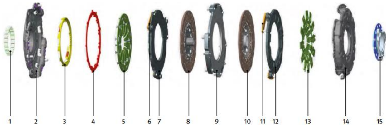
Слика 4.24. Елементи двоструке спојнице (Alfa Romeo – Fiat C635 DDCT): 1. зупчаник (озубљен), 2. поклопац спојнице 1, 3. прстен за подешавање, 4. опруга (сензор), 5. тањираста опруга, 6. тангенцијална лисната опруга 1, 7. потисна плоча, 8. спојница 1, 9. централна (средишња) плоча, 10. спојница 2, 11. тангенцијална лисната опруга 2, 12. потисна плоча 2, 13. тањираста опруга, 14. поклопац спојнице 2, 15. прирубнички лежај
