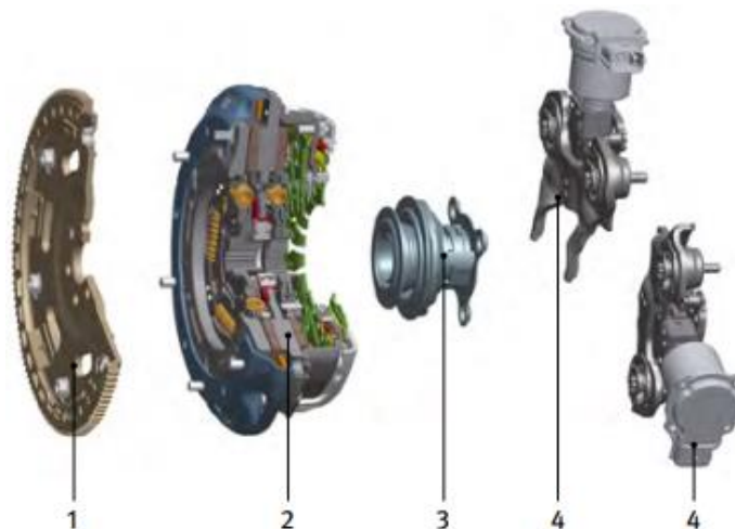
Слика 4.15. Двострука спојница са сувим фрикционим површинама (Ford 1.6 – 2.0, 6-степенни мењачки преносник DPS6): 1. замајац, 2. двострука спојница, 3. водећа чаура са причврслним лежајем, 4. покретачка полуга са сервомоторима [8]
