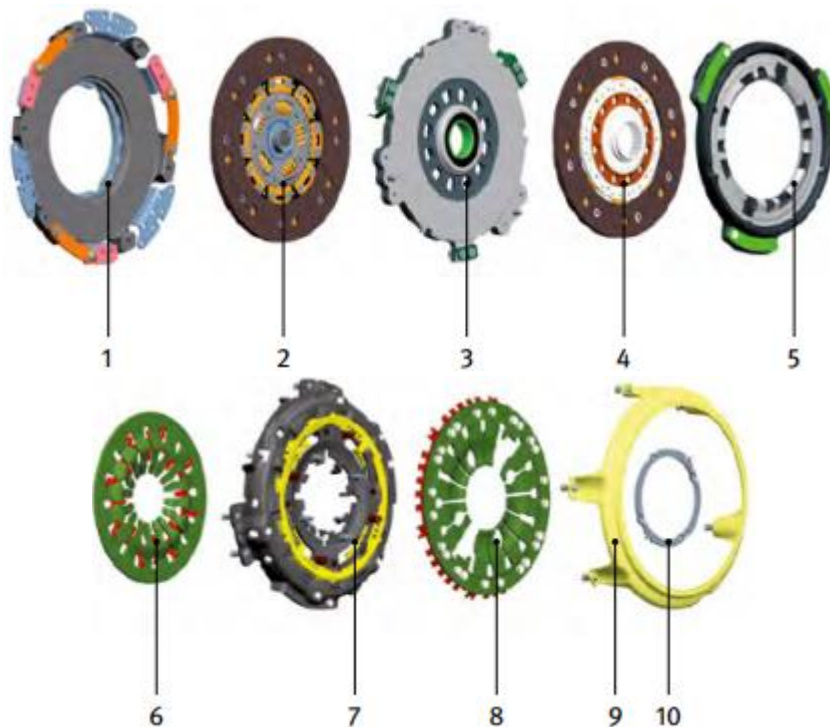
Слика 3.3. Елементи двоструке спојнице са сувим фрикционим површинама: 1. погонски прстен са потисном плочом, 2. фрикциони диск 1, 3. средишња плоча, 4. фрикциони диск 2, 5. потисна плоча, 6. тањираста опруга са механизмом за подешавање фрикционог диска 2, 7. поклопац спојнице са механизмом за подешавање фрикционог диска 1, 8. тањираста опруга, 9. спона, 10. зауставни прстен [8]
