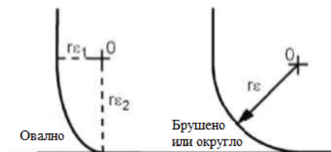
Слика 15: Профили са брушеним резним угловима за тешку машинску обраду [3]
