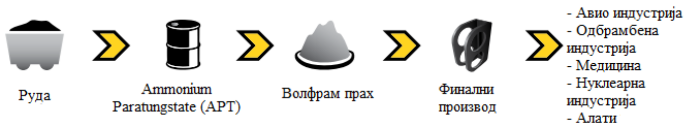
Слика 1: Упрошћена шема добијања производа од легуре тешког метала [9]
