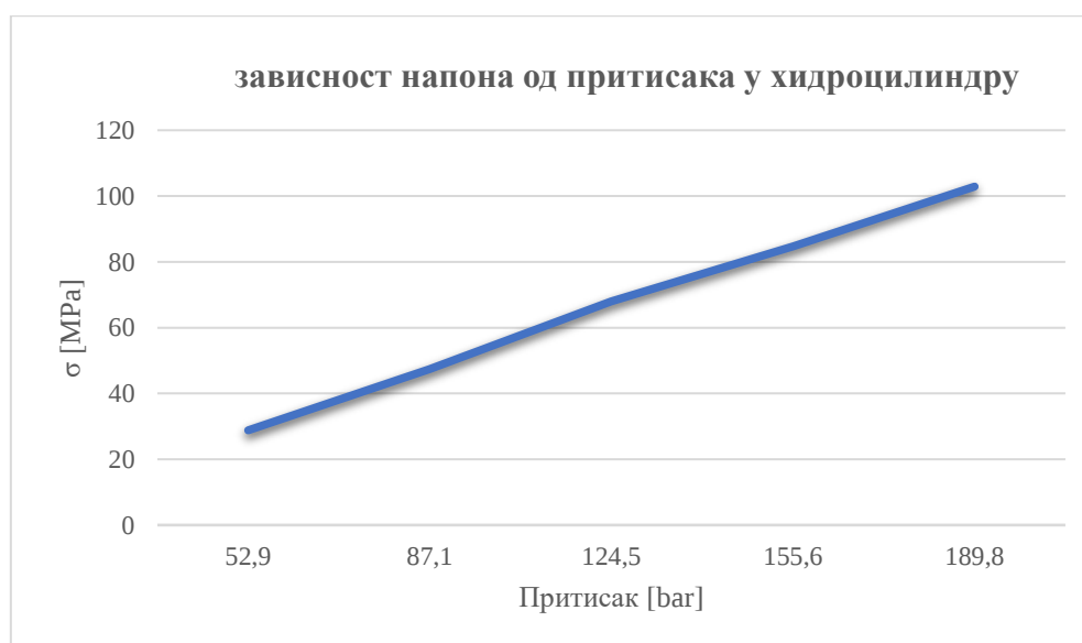
Слика 6.25 Дијаграмски приказ пораста напона у материјалу при деловању различитих вредности притисака
