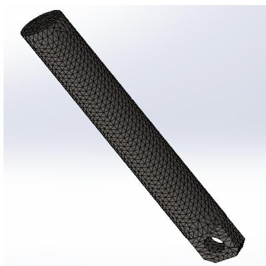
Слика 6.3 Формирање мреже коначних елемената
