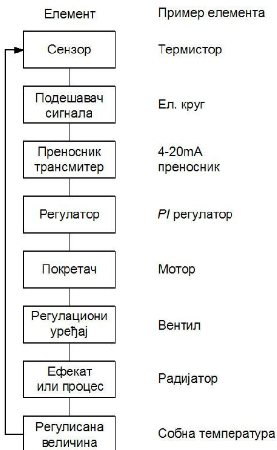
Слика 9.1 – Шематски приказ компонената регулационог круга
