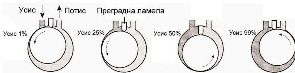
Слика 8.10 – Ротациони компресор са обртним клипом [10]
