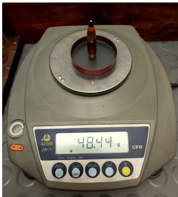
Слика 46: Приказ измерене вредности масе зрна код групе са НЦ барутом ( зрна која се не користе)
