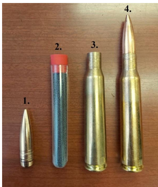
Слика 41: 1. Ball зрно (које се користи у опиту) 2. СБ барут 3. Месингана чаура са бердан капислом (произведена 2019. године, која се користи у опиту) 4. Метак за три групе муниције (СБ група)
