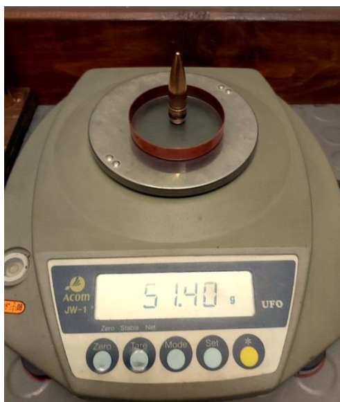
Слика 45: Приказ измерене вредности масе зрна код групе са СБ барутом
