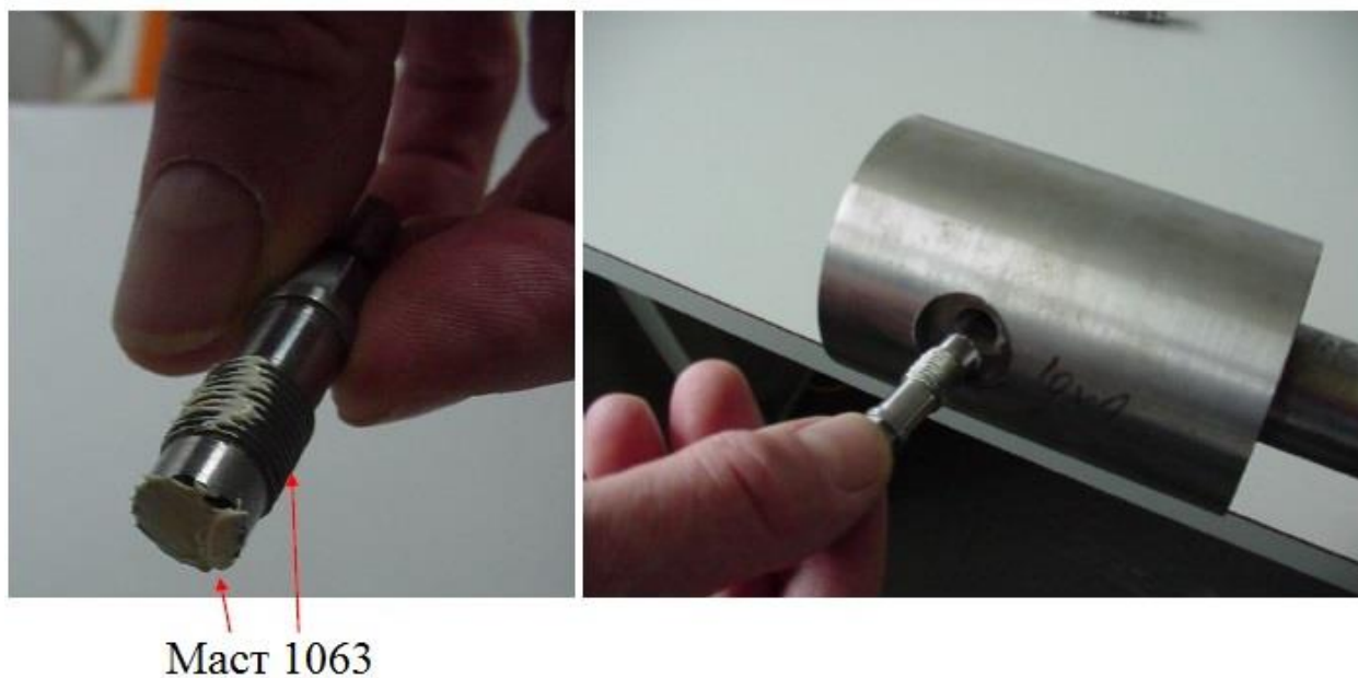
Слика 31: Приказ наношења масти на развртач за обраду и завијања у лежиште сонде
