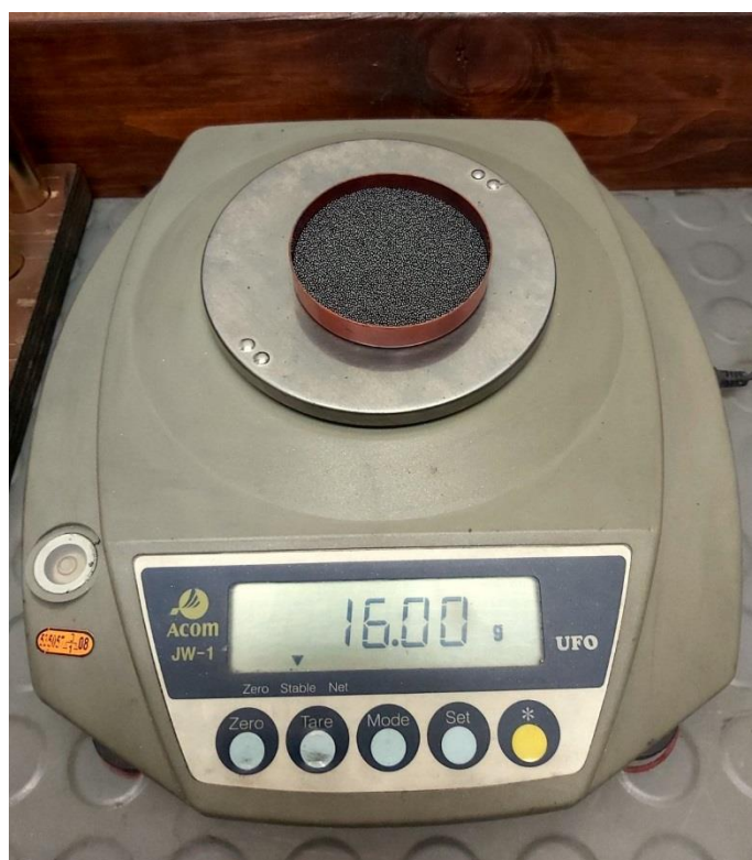
Слика 44: Приказ измерене вредности барутног пуњења са СБ барутом
