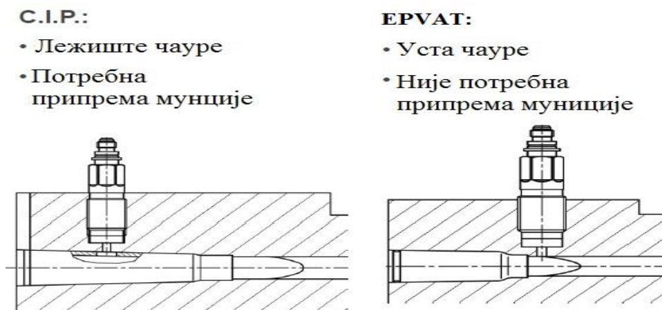
Слика 47: Шема мерних места притисака за С.І.Р и ЕРВАТ методу
