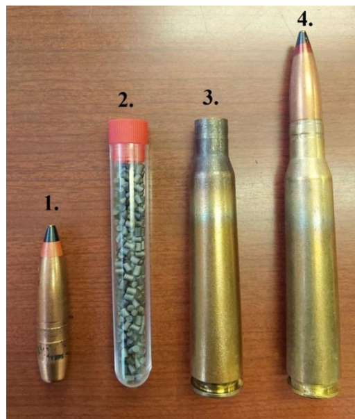
Слика 42: 1. Панцирно запаљиво зрно (које се не користи у опиту) 2. НЦ барут 3. Месингана чаура са бердан капислом (произведена 1984. године, која се не користи у опиту) 4. Фабрички метак (НЦ група)
