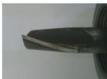
Слика 5.2 Глодало коришћено за експеримент [10]
