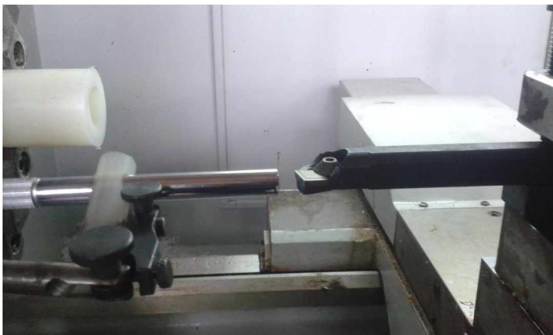
Слика 6.7 Положај камере и алата за унутрашњу обраду
