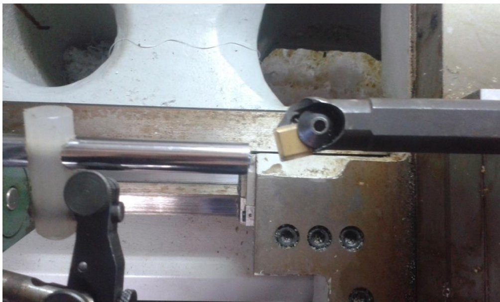
Слика 6.23 Положај камере и изглед резне плочице 8 за унутрашњу обраду
