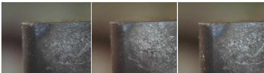
Слика 6.15 Резна плочица 5 и похабане површине на резној плочици 5
