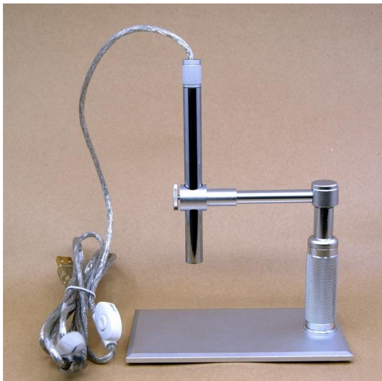
Слика 6.2 Микроскопска камера коришћена у експерименту
