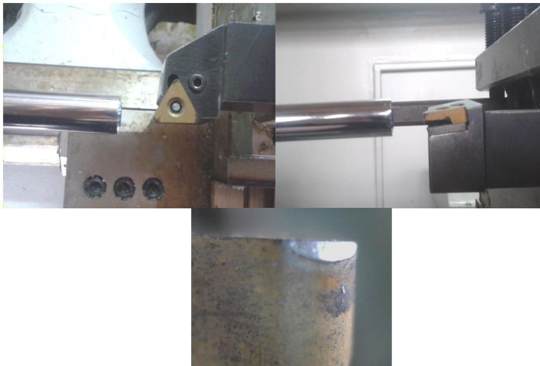
Слика 6.13 Похабана помоћна леђна површина резне плочице 3
