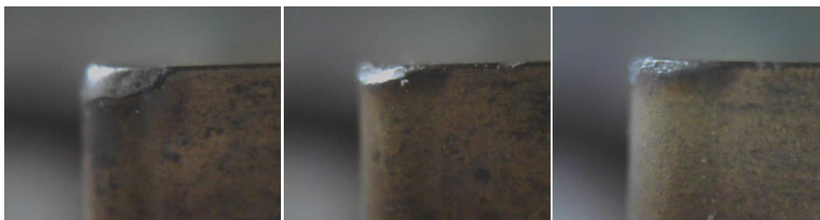
Слика 6.9 Похабане површине резне плочице 1
