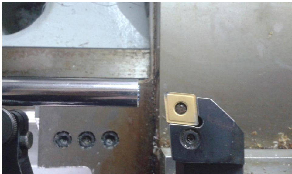
Слика 6.17 Мерење похабаности леђне површине ромбоидне плочице 7
