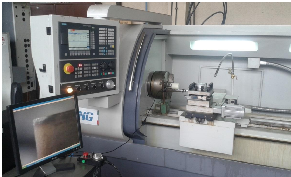
Слика 6.3 Мерни систем сачињен од рачунара (лево), CNC струга и микроскоп камере који омогућује у реалном времену снимање слике или видео запис
