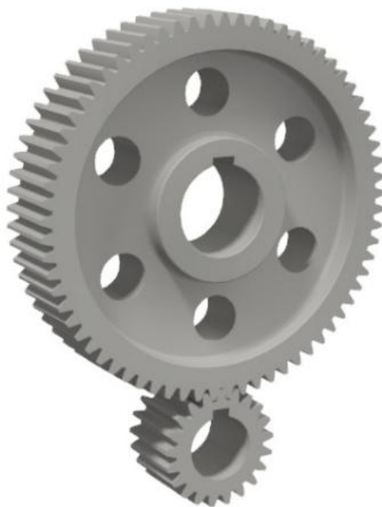
Слика 4.8. Зупчасти пар z_a и z_g
