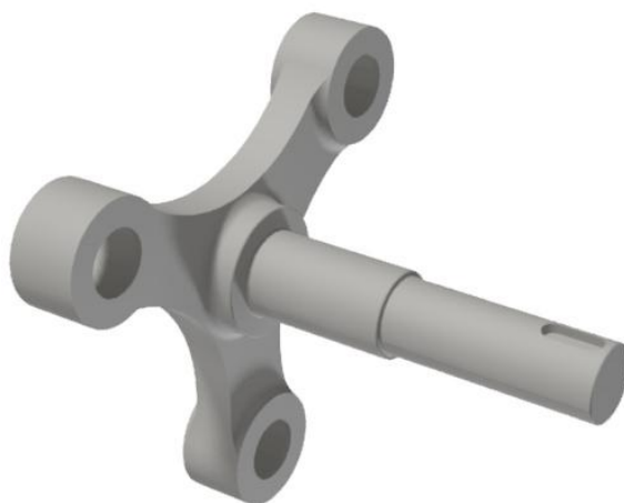
Слика 4.12. Идеални пречник улазног вратила и изглед улазног вратила
