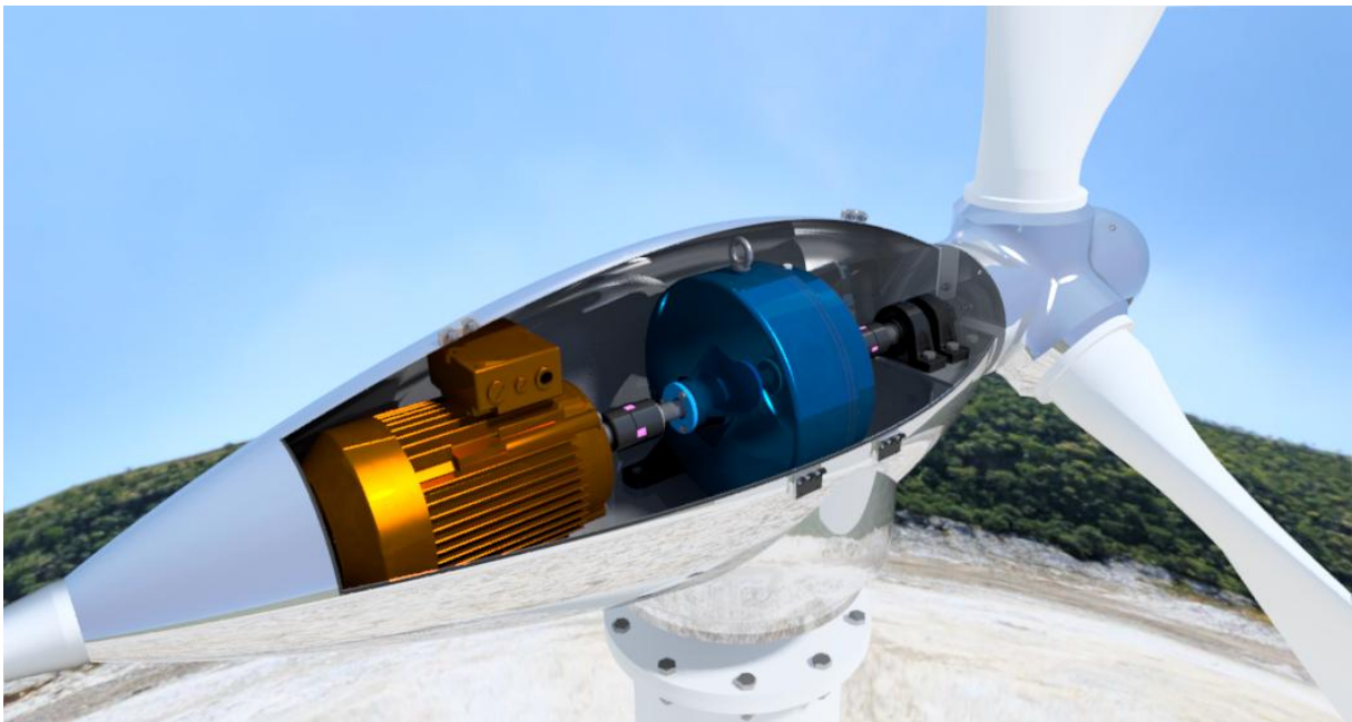
Слика 6.1. Унутрашњи делови ветрогенератора
