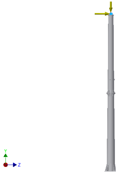
Слика 3.6. Силе које делују на стуб
