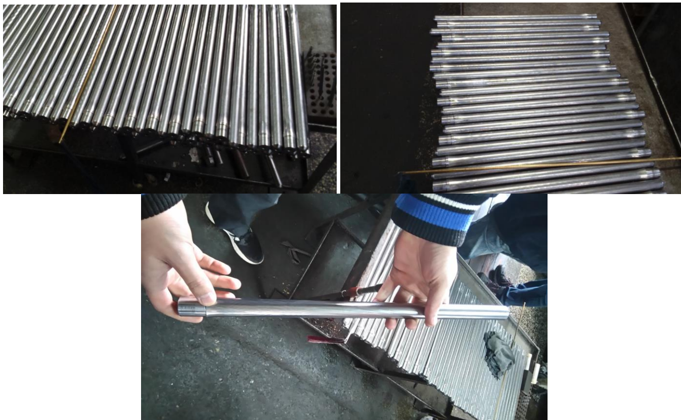
Слика 5.20. Отковане цеви
