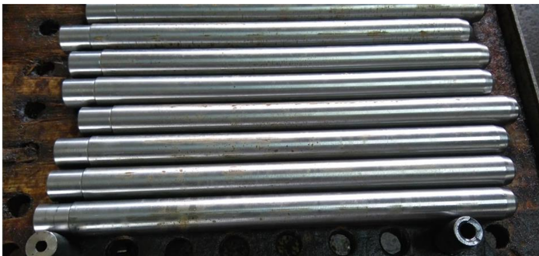
Слика 4.5. Припремци цеви кал. 7,62x39 mm за ковање
