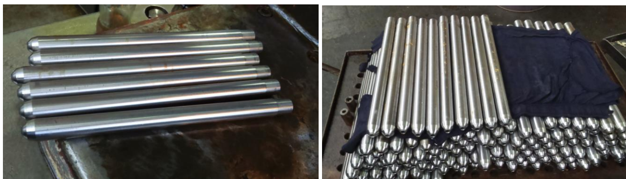
Слика 5.17. Припремци за ковање
