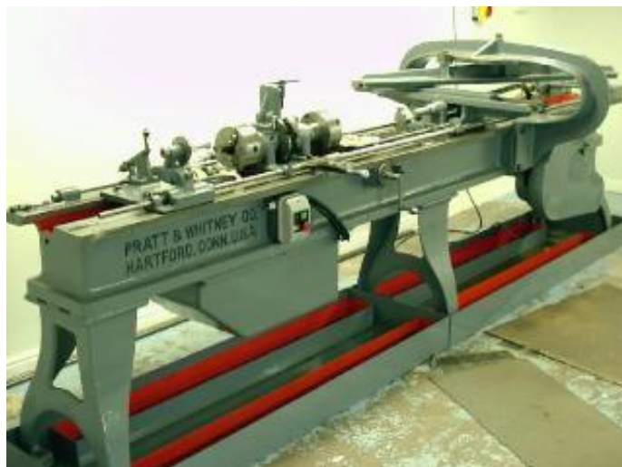
Слика 2.1 Машина за ожљебљење резањем
