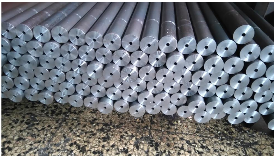
Слика 5.15. Изглед цеви после процеса дубоког бушења
