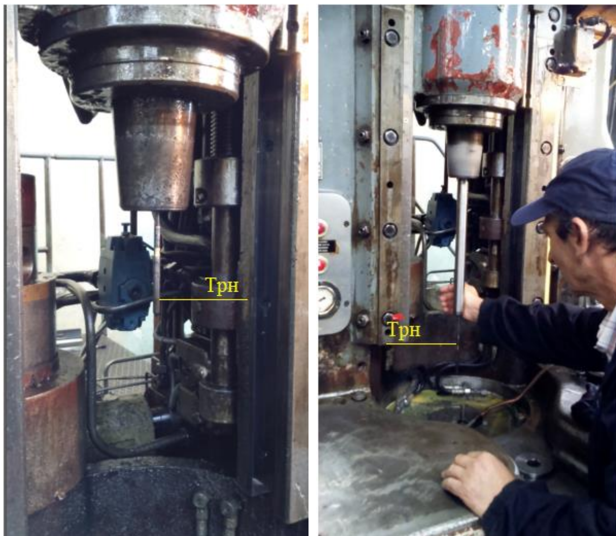
Слика 5.18. Изглед трна пре постављеног припремке (лево) и после постављања припремке и пробе излажења трна пре ковања (десно)
