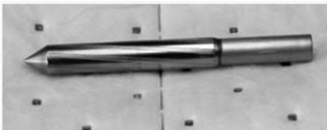
Слика 5.1. Трн за ковање
