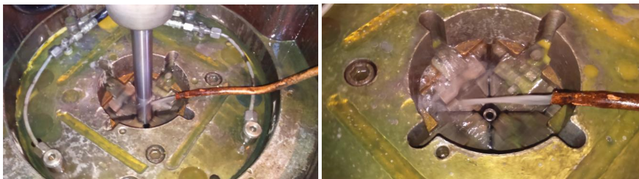
Слика 5.19. Почетак процеса ковања и изглед чекића
