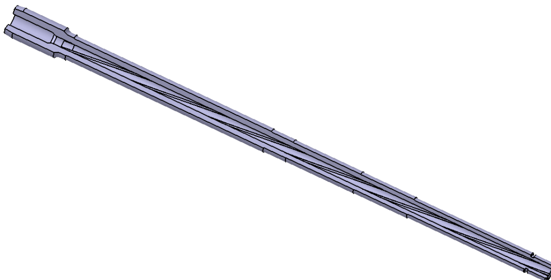
Слика 3.4. Пресек ожљебљене цеви аутоматске пушке калибра 7,62x39 mm
