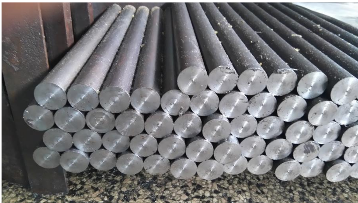
Слика 4.1. Ваљане цилиндричне шипке које се користе за производњу цеви кал. 7,62x39 mm
