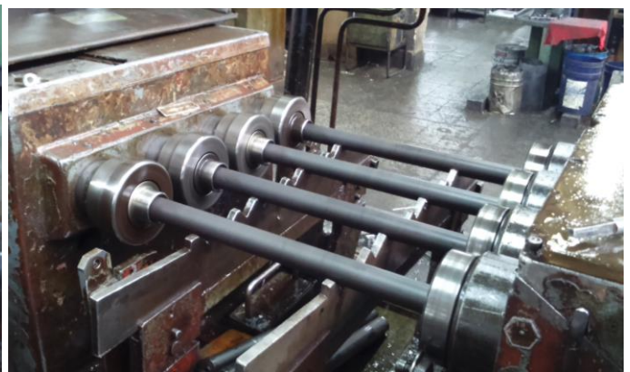
Слика 5.14. Машина за бушење без припремака а) и са постављеним припремцима б)
