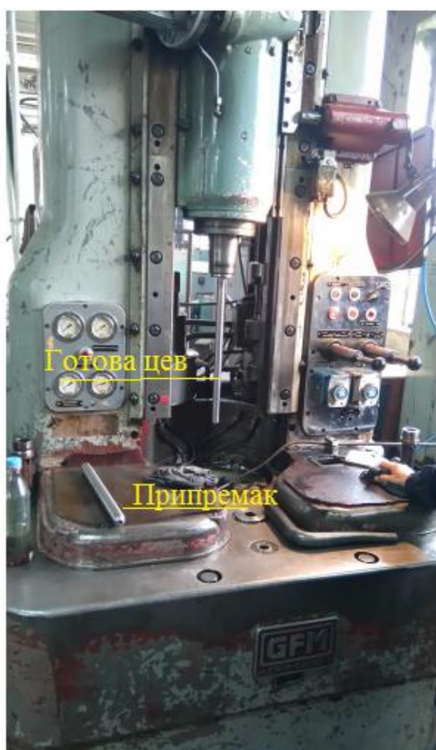
Слика 5.6. Машина за ковање
