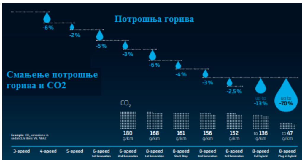
Слика 70. Тренд смањења потрошње горива и емисије CO 2 са развојем мењача [13]
