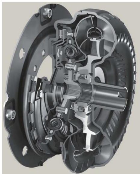
Слика 8. Пресек хидродинамичког мењача
