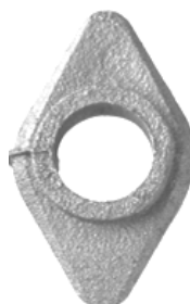
Слика 24 - Храпавост на површини целог одливка
