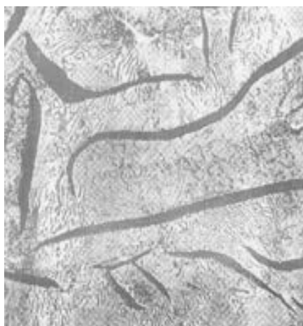
Слика 6 - Микроструктура сивог лива (тамне пруге су ламеле графита)
