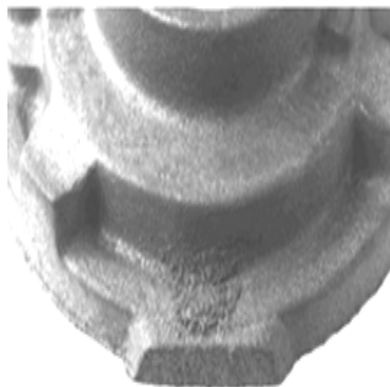
Слика 22 - Храпавост на горњој површини одливка
