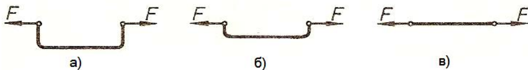
Слика 22 - Полуке облика а) и б) изложене су моментима савијања, а полука облика в) само затезању
