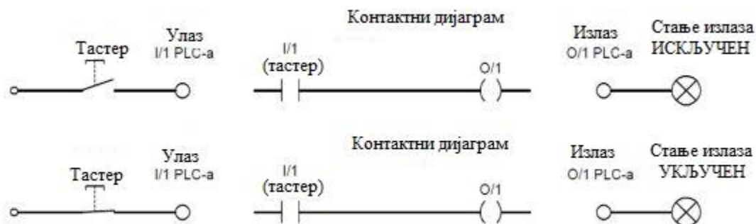
Слика 12.5 Пример лествичастог дијаграма[11].
