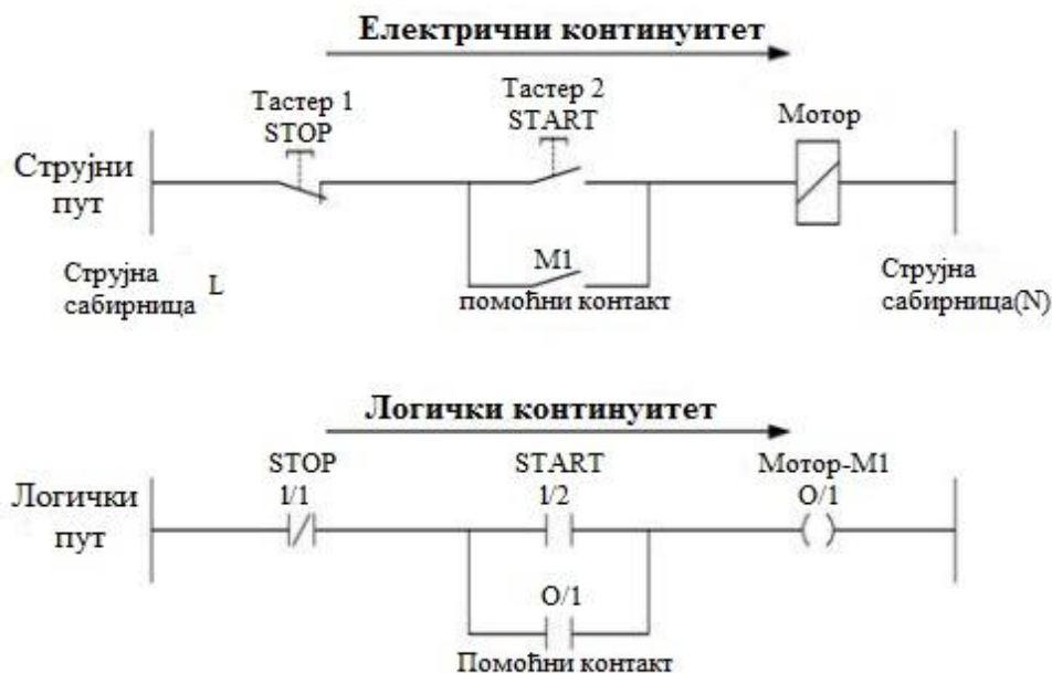
Слика 12.4 Поређење струјног и логичког пута[11].
