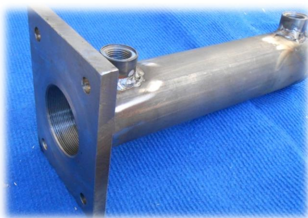
Слика 6.1.5 Прирубница заварена за цев цилиндра
