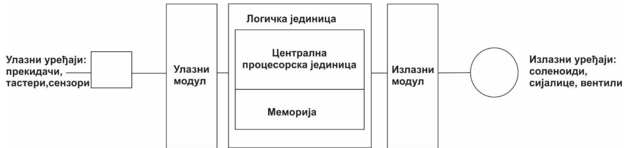
Слика 4. Основни елементи програмабилног логичког контролера
