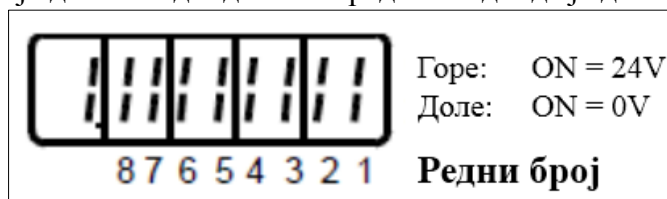
Слика 28. Распоред LED диода у приказу улазних сигнала[5]
