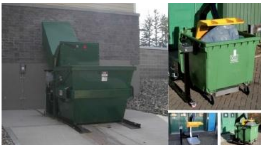
Слика 2.4- Контејнери са компакторима
