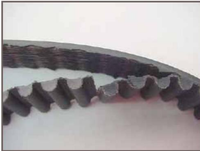
Слика 30. Одвајање зуба каиша у облику траке
