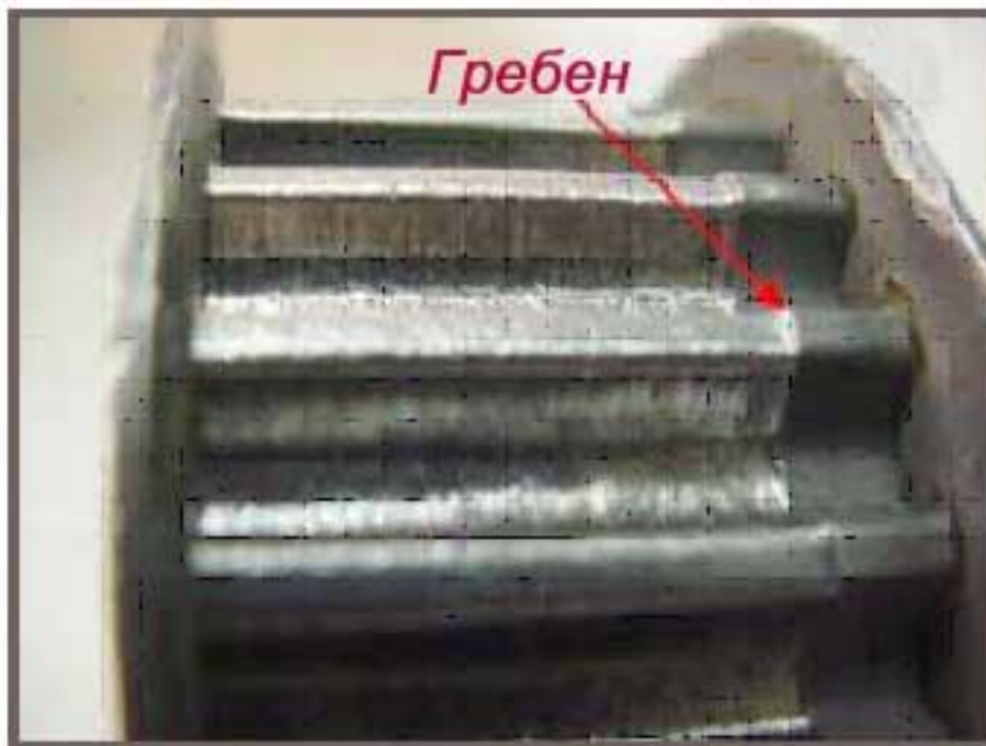
Слика 37. Гребен на зубу похабаног каишника
