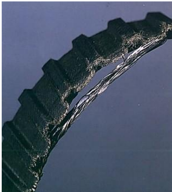
Слика 50. Хабање бочне ивице каиша
