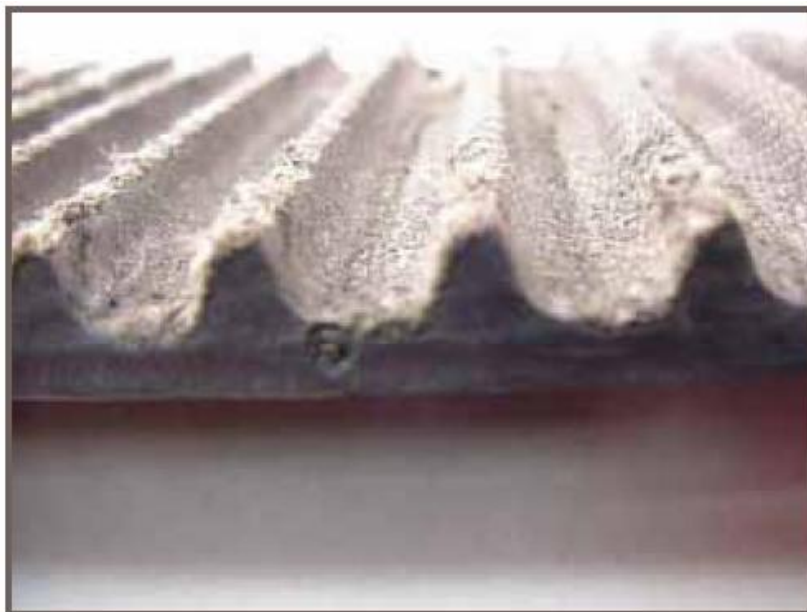
Слика 31. Последица неодговарајућег спрезања са међузубљем каишника
