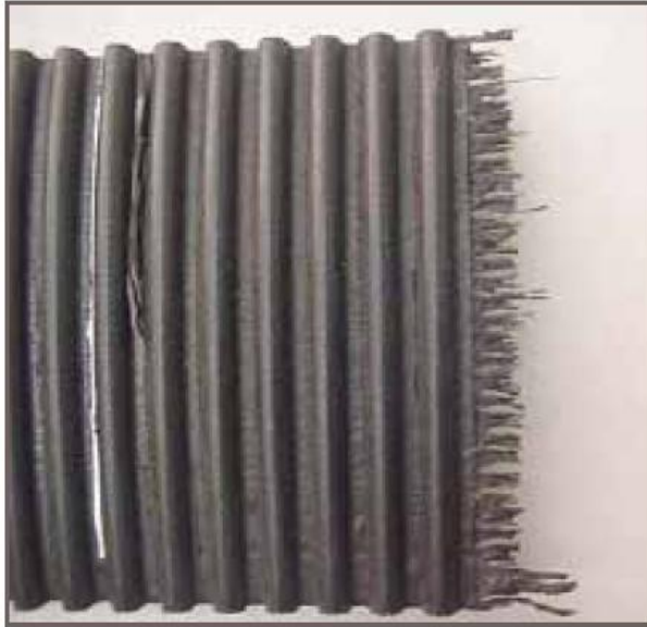
Слика 25. Раван тип прекида каиша
