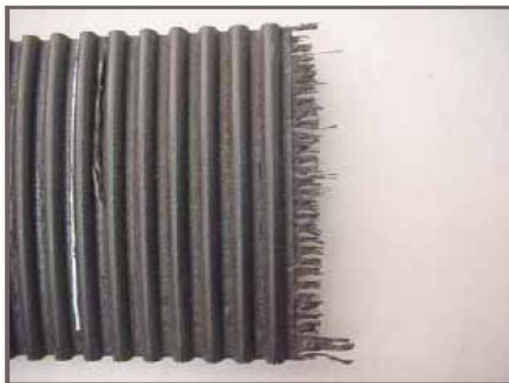
Слика 43. Кудање вучног елемента каиша
