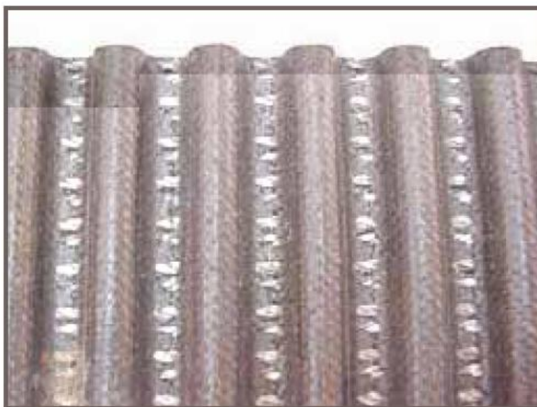
Слика 29. Хабање каиша услед прекомерне затегнутости
