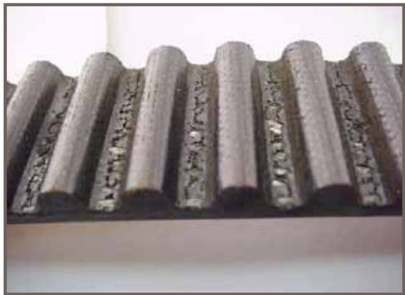
Слика 36. Распадање међузубља каиша
