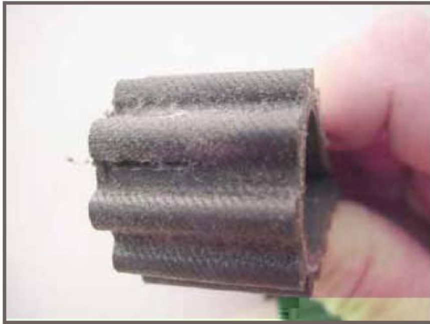
Слика 34. Концентрисано хабање бокова зуба
