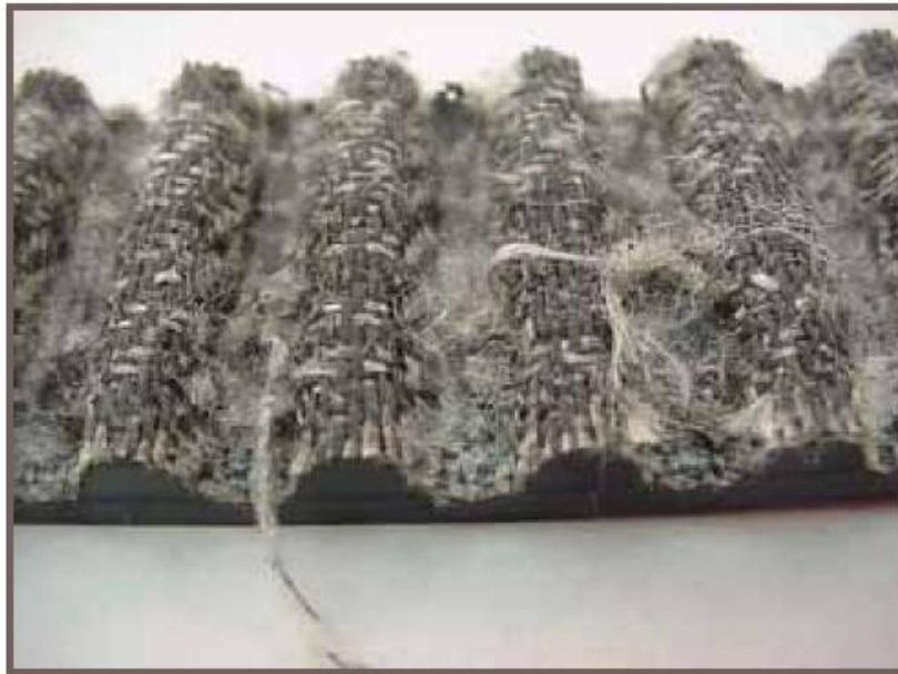
Слика 35. Хабање каиша узроковано спрезањем са нестандардним каишницима
