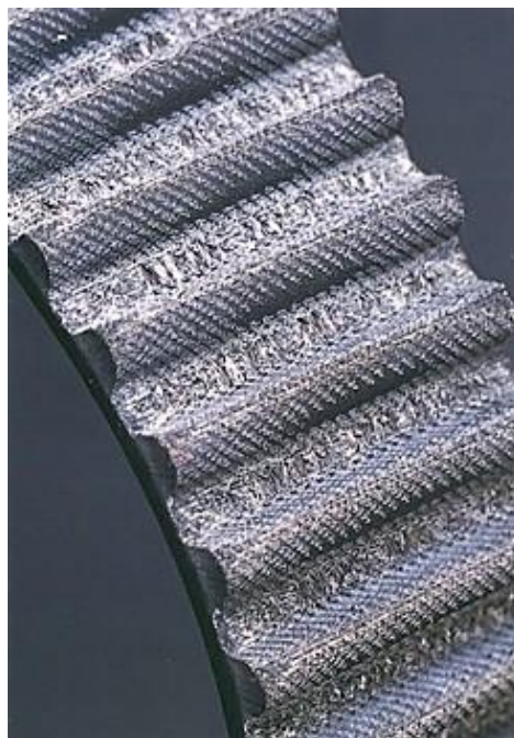
Слика 48. Хабање међузубља
