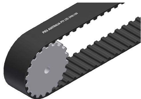
Слика 10. Спрега зупчастог каиша са каишником
