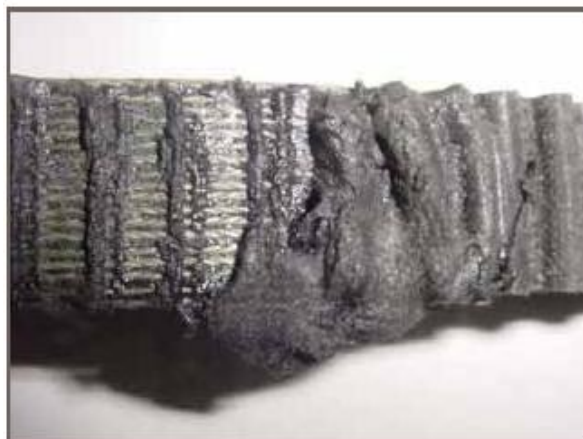
Слика 41. Зупчасти каиш изложен високим температурама
