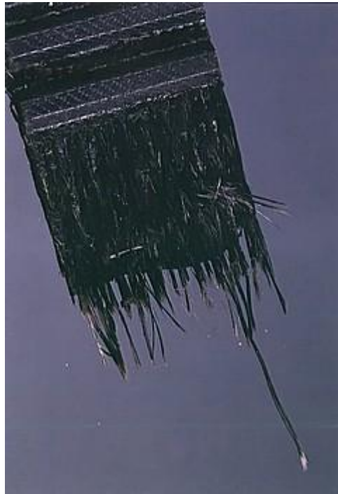
Слика 51. Зупчасти каиш после дужег контакта са уљем
