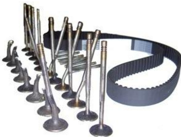
Слика 54. Искривљени вентили - последица кидања зупчастог каиша
