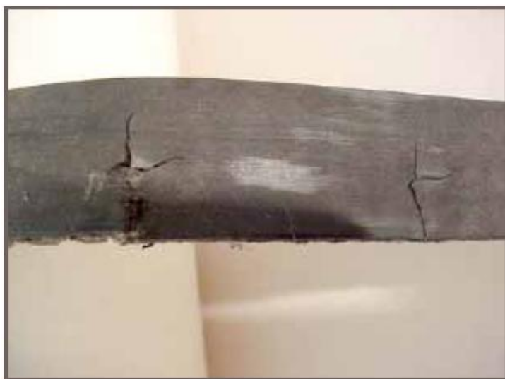
Слика 42. Делимично кидање вучног елемента
