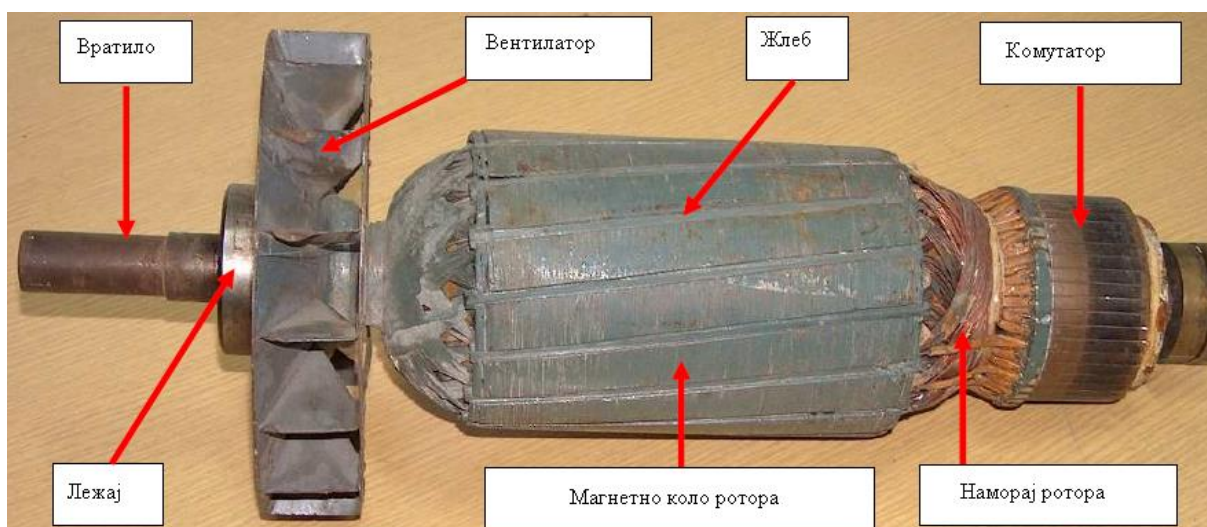
Слика 19. Ротор генератора једносмерне струје [8]
