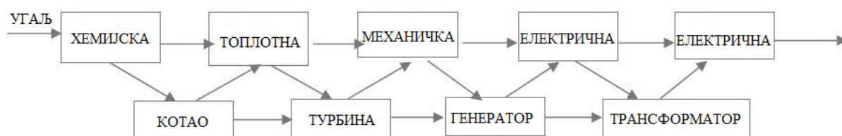
Слика 5. Технолошка шема производње електричне енергије из угља
