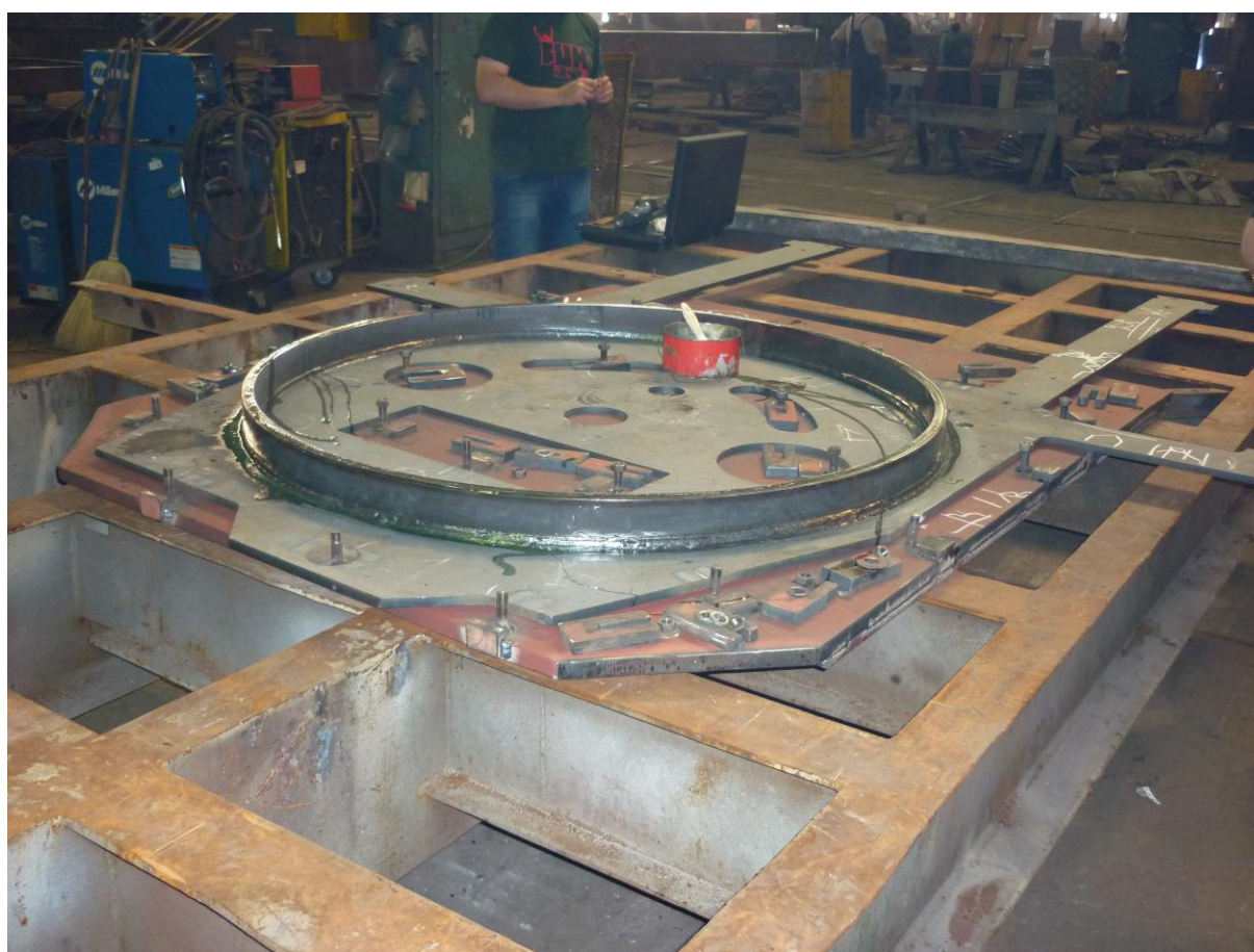
Слика 6.10 Израда одговорног склопа од челика Weldom 700 [16]
