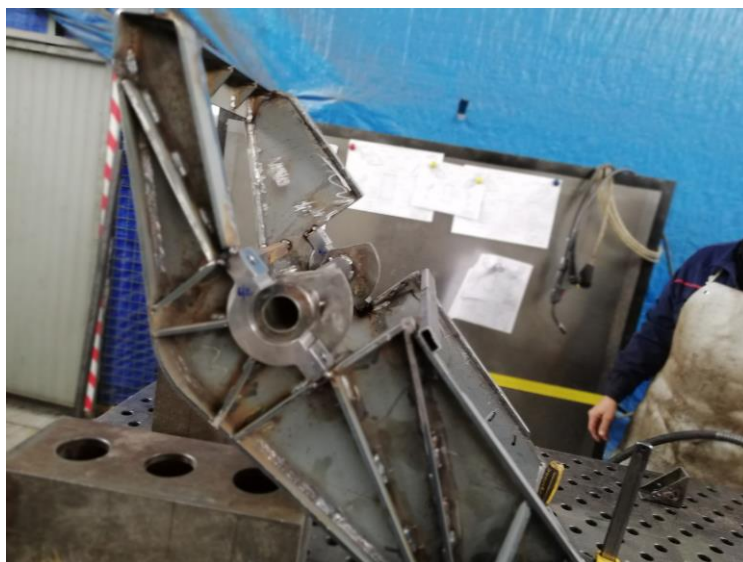
Слика 6.9 Израда одговорног склопа од челика Weldom 700 [16]
