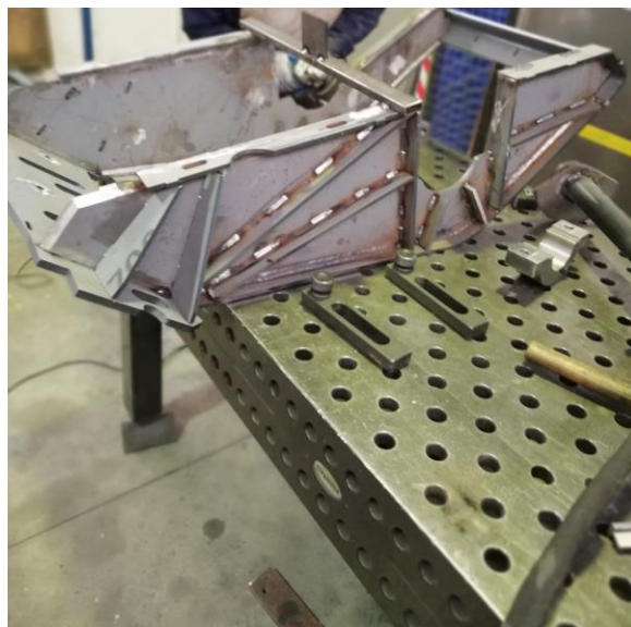
Слика 6.8 Израда одговорног склопа од челика Weldom 700 [16]
