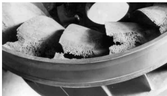
Слика 34. Радно коло Франсисове турбине оштећено кавитацијом
