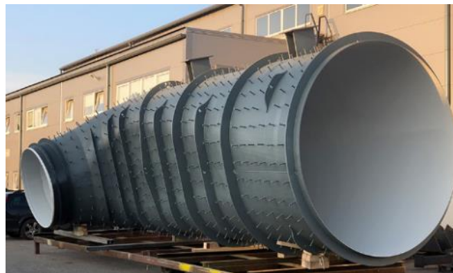
Слика 30. Дифузор франсисове турбине
