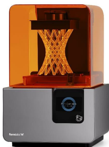
Слика 4. SLA штампач лево, и модел израђен том технологијом десно [9]
