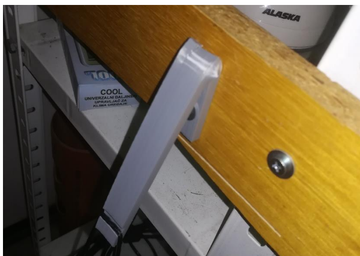
Слика 44. Лом куке од чистог ABSa
