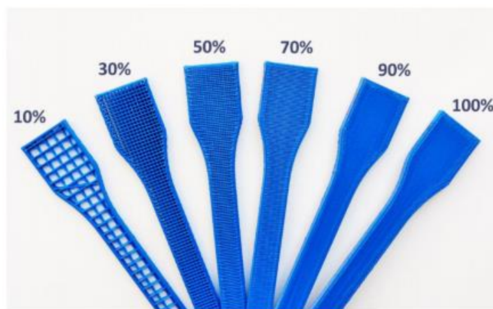
Слика 13. Приказ различитих процената унутрашње попуне од 10% до 100%
