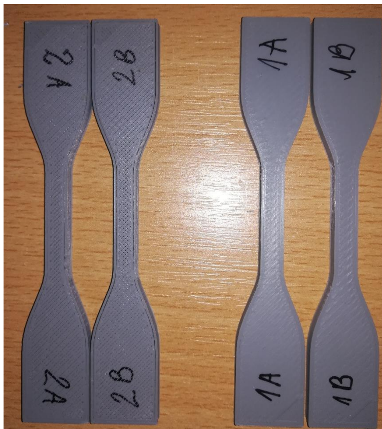
Слика 30. Одштампани узорци за испитивање: контролни узорци од чистог ABS-а (1A и 1B) и композитни узорци (2A и 2B)
