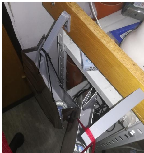
Слика 43. Поставка за испитивање кука, почетни положај (лево) и након првог оптерећења (десно)
