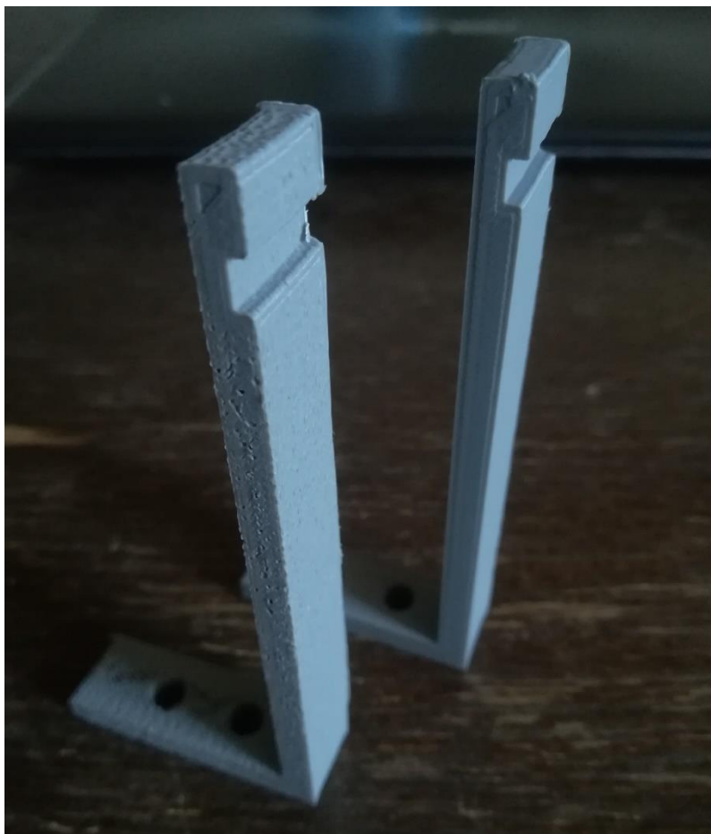
Слика 42. Одштампане куке од композитног (лево) и чистог ABS материјала (десно)
