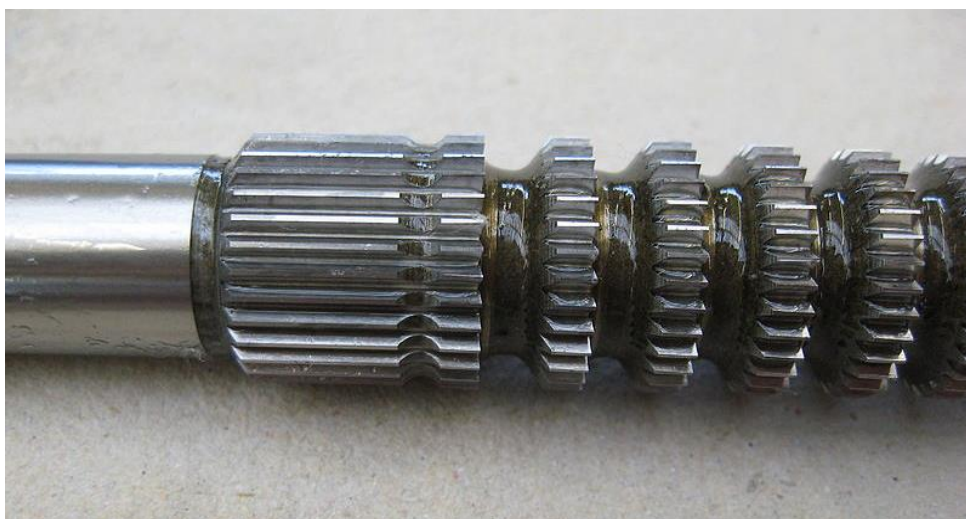
Слика 3.3. Пример провлакача за унутрашње провлачење
