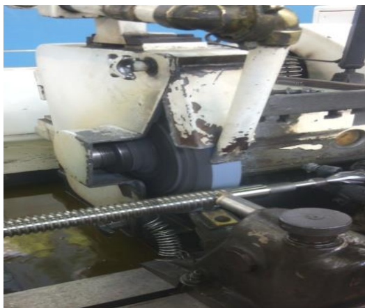
Слика 4.21. Округло брушење
