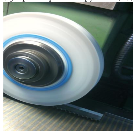
Слика 4.10. Мерно брушење
