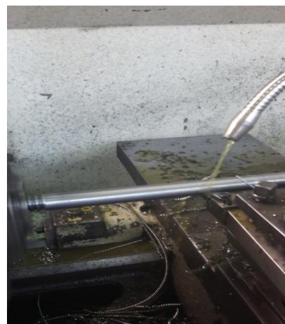
Слика 4.17. Израда вучног и прихватног дела.
