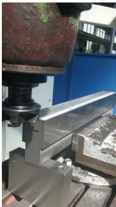
Слика 4.4. Операција уздужног глодања
