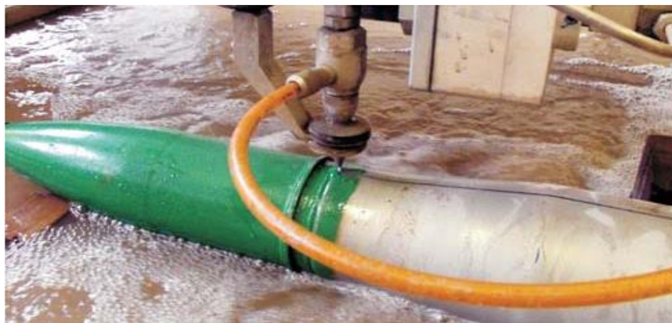
Слика 17. Експериментално резање противтенковског метка са абразивним воденим млазом [1]
