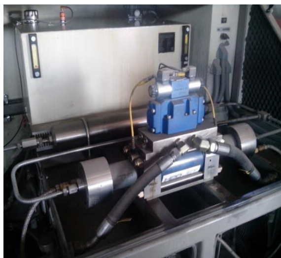
Слика 30. Систем за постизање високог притиска и мултипликатор у систему за постизање високог притиска [5]
