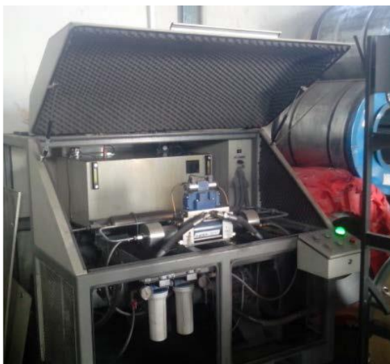
Слика 30. Систем за постизање високог притиска и мултипликатор у систему за постизање високог притиска [5]
