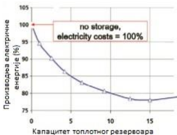
Слика 19 Однос трошкова производње електричне енергије и капацитета топлотног резервоара
