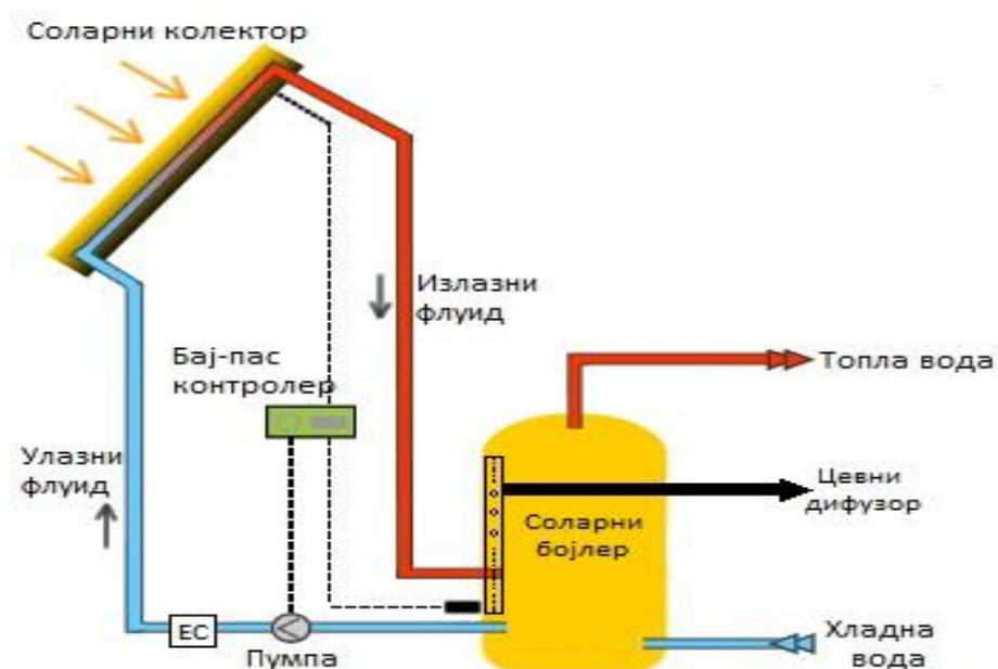
Слика 10 Соларни систем за коришћење топле воде у домаћинству
