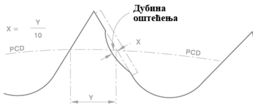
Слика 39. Индикатор хабања зуба ланчаник,[20]
