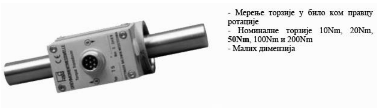
Слика 30. Давач обртног момента „HBM-T5, 50Nm“, [16]
