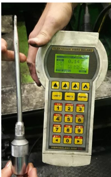
Слика 26. Уређај за мерење вибрација
