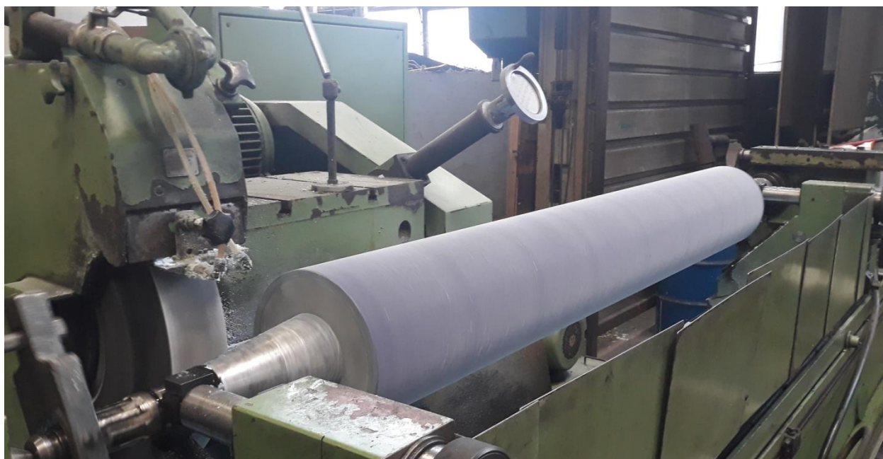
Слика 13. Обрада и одржавање цилиндричности полиуретанског ваљка
