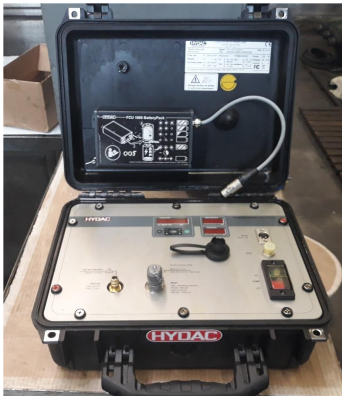
Слика 30. Уређај за мерење количине контаминаната у уљу
