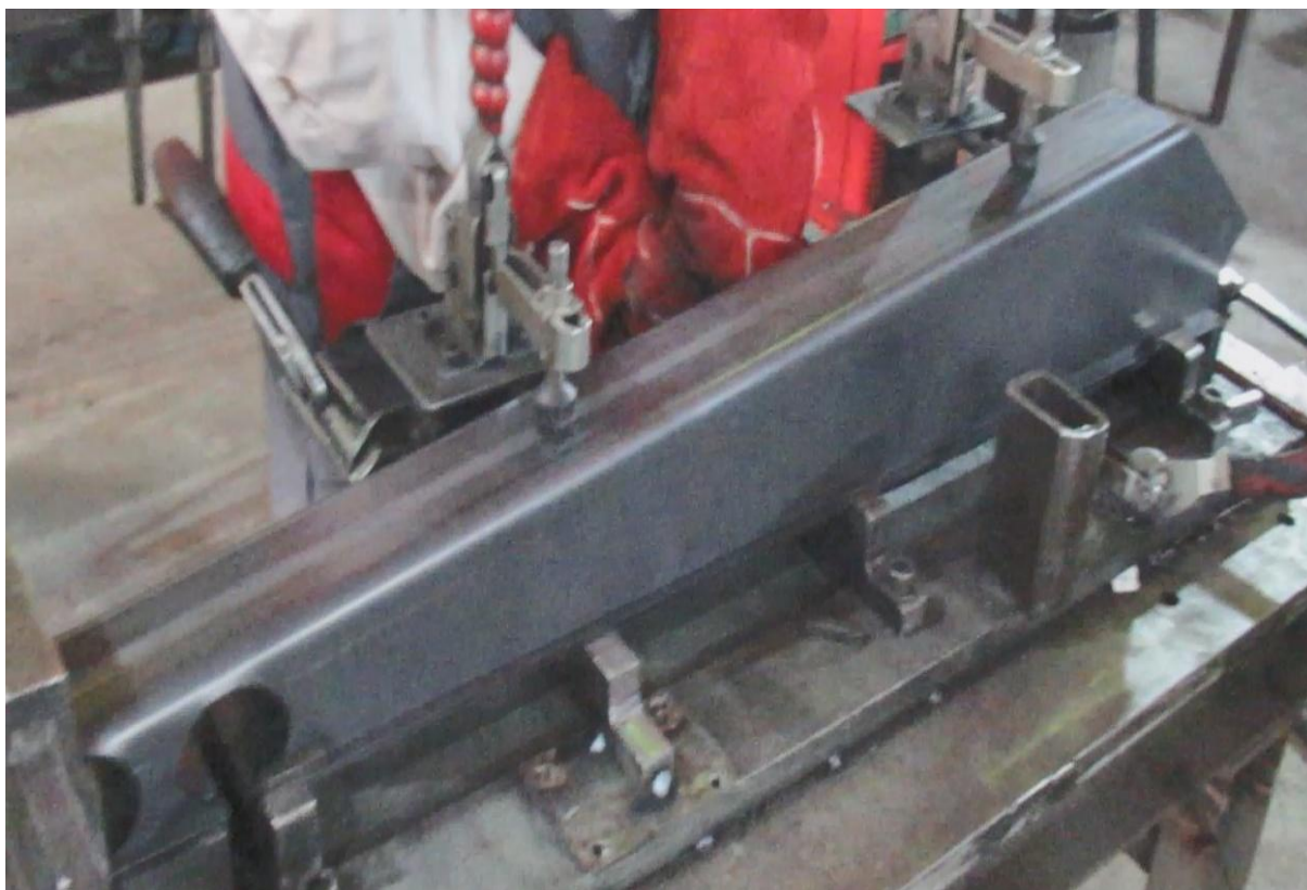
Слика 37. Позиционирање модела Löffelstiel 803 у алат
