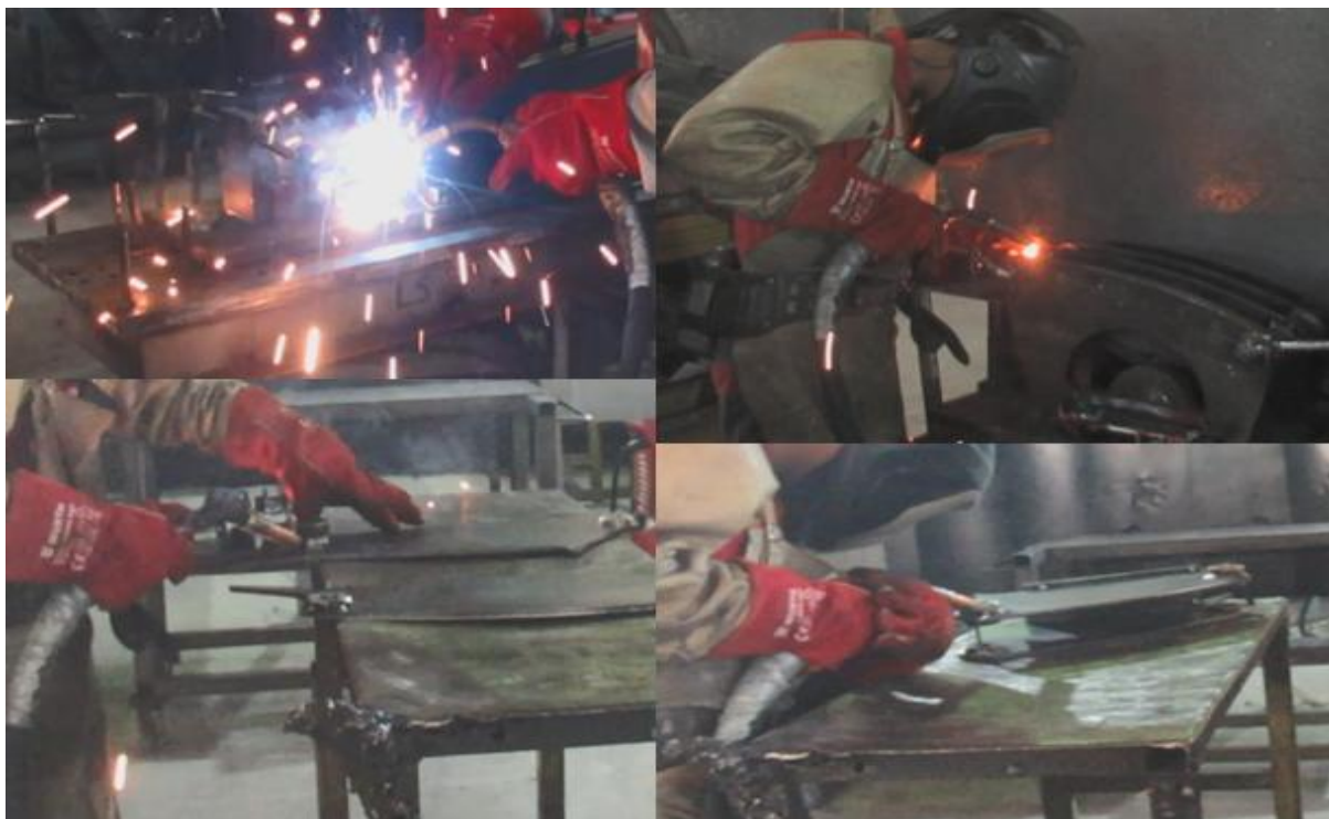
Слика 39. Приваривање лаше
