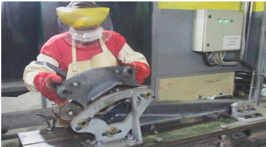
Слика 40. Операција склапања производа Löffelstiel 803
