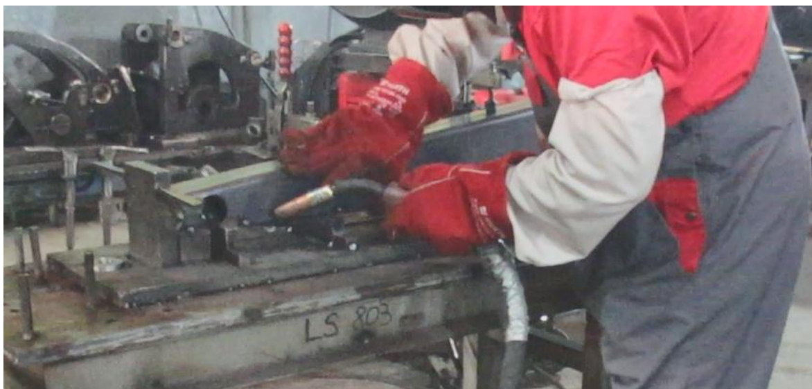
Слика 38. Операција склапања производа Löffelstiel 803
