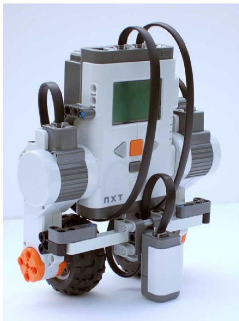
Сл.4.9. Пример конкретне употребе NXT Lego сервомотора (HTWay – Lego Segway, пример инверзног клатна)
