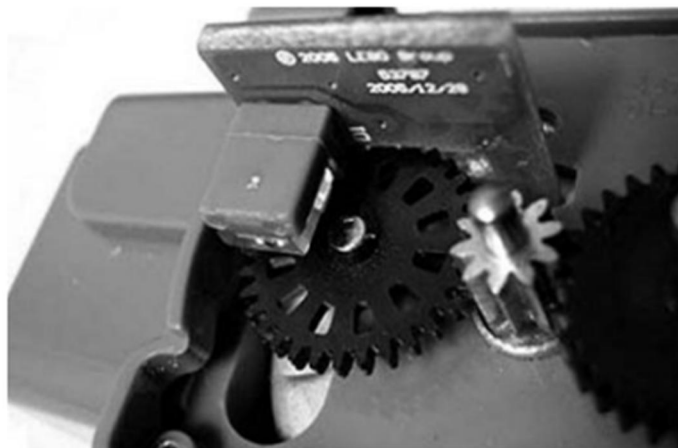
Сл.4.3. Сензор ротације сервомотора [19]
