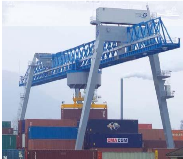
Слика 3.11 Рамна дизалица комбиноване конструкције [5]
