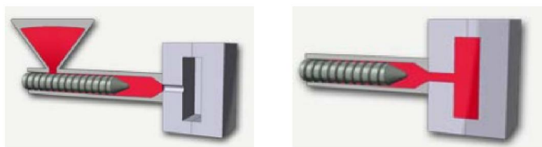
Слика 10. Поступак попуњавања калупне шупљине (5)
