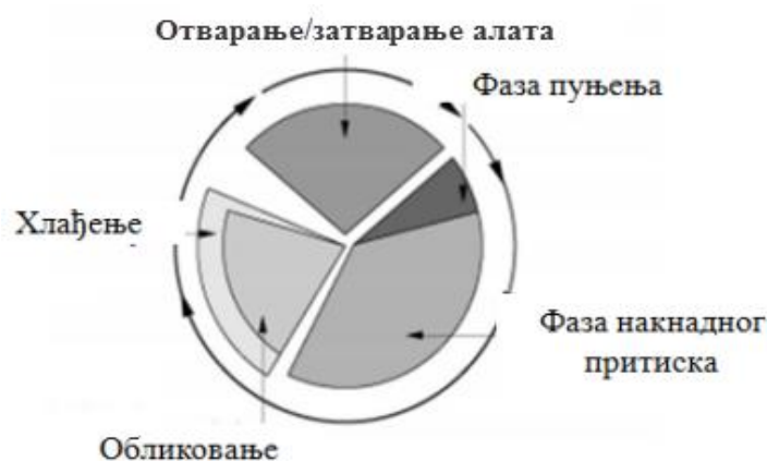
Слика 9. Основни циклуси процеса бризгања (5)
