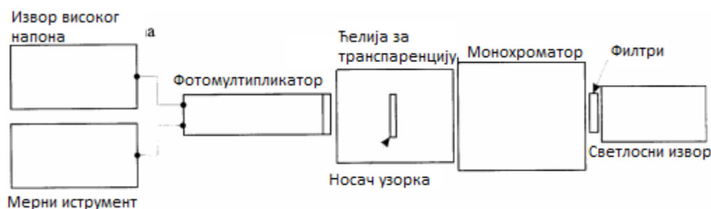
Слика 15 – Блок шема спектрометра [11].
