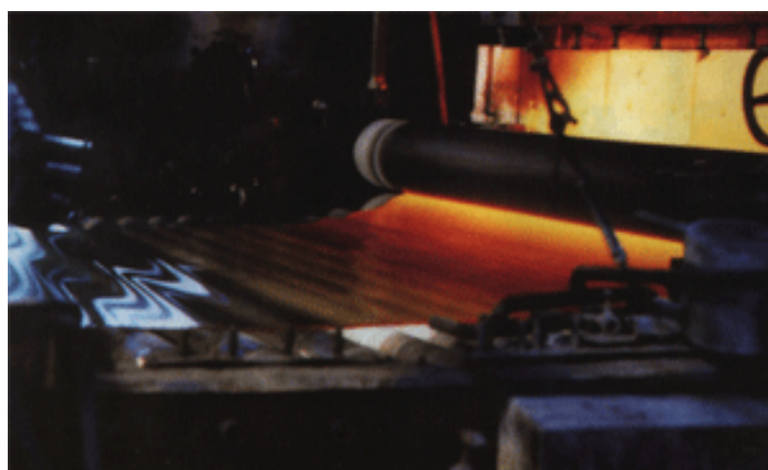
Слика 6. – Извлачење стакла пресом
