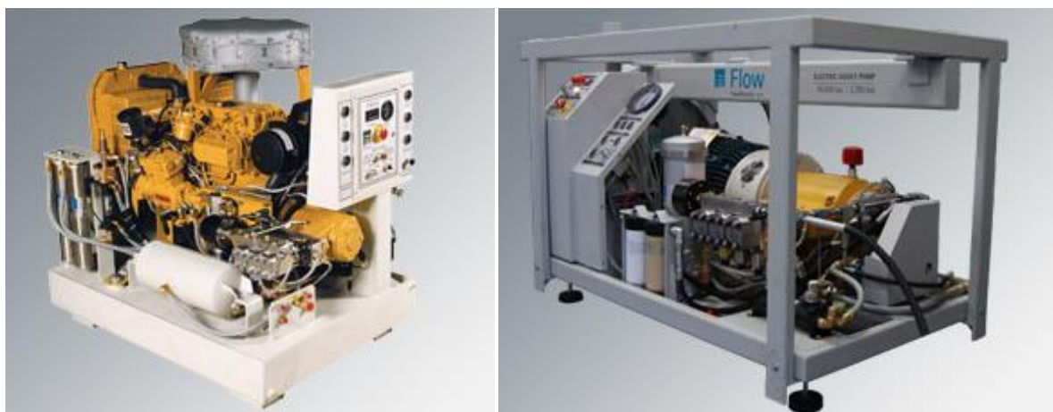
Slika 3.46. Pumpe visokog pritiska motornog (levo) i električnog (desno) pogona
