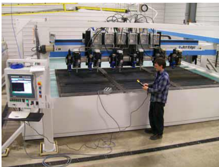
Slika 3.37. Konstrukcija mašine za 2D obradu vodenim mlazom sa šest reznih glava
