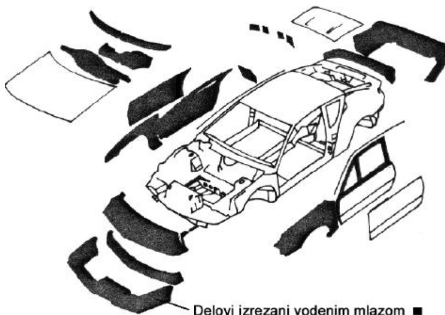
Slika 3.54. Primer delova od plastike za vozila Renault izrezanih vodenim mlazom
