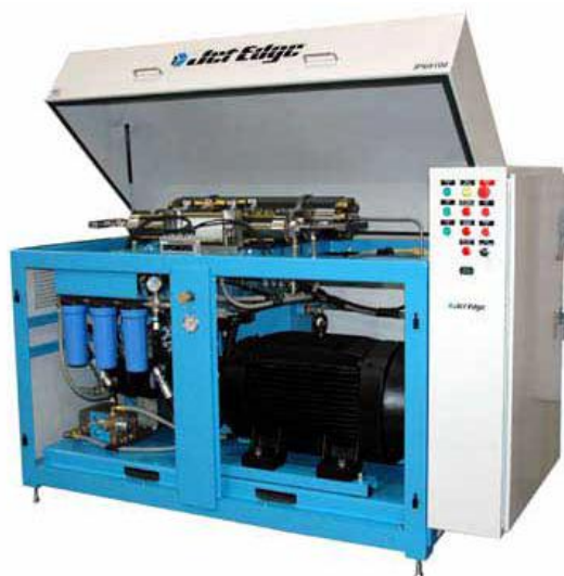
Slika 3.25. Pumpa visokog pritiska – spoljašnji izgled proizvođač JetEdge
