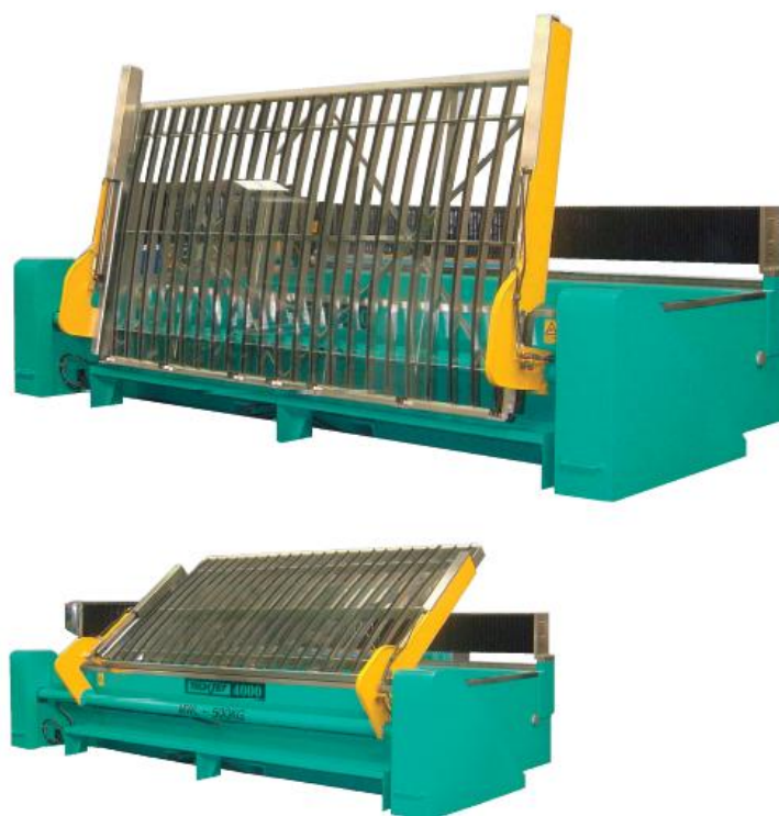
Slika 3.38. Stolovi sa hidrauličnim sistemom za postavljanje radnih predmeta
