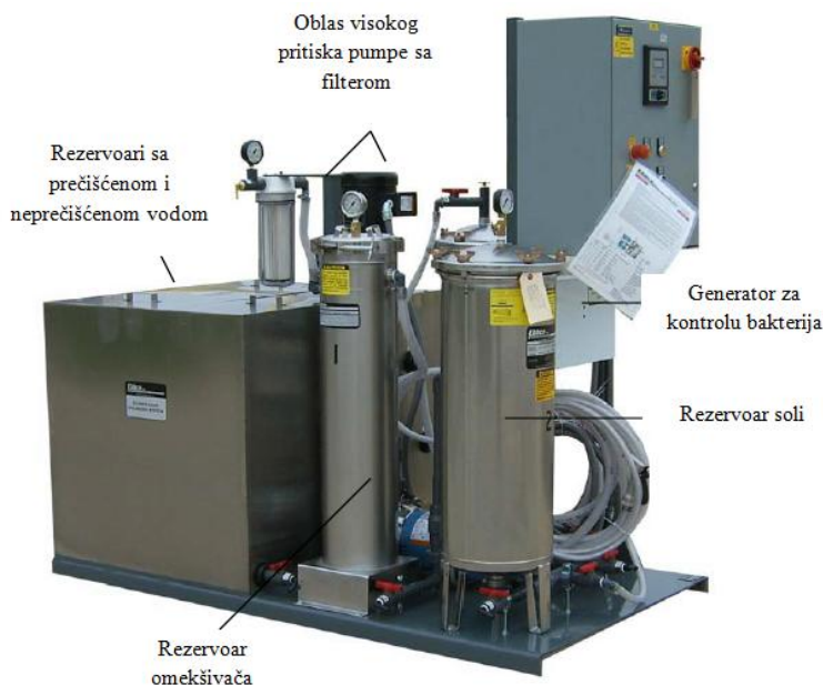
Slika 3.14. Sistem za pripremu vode sa rezervoarima kompanije JetEdge
