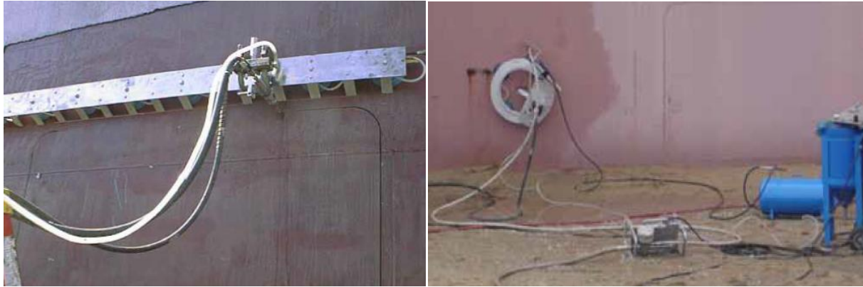
Slika 3.49. Mobilni sistem za sečenje vertikalnih površina
