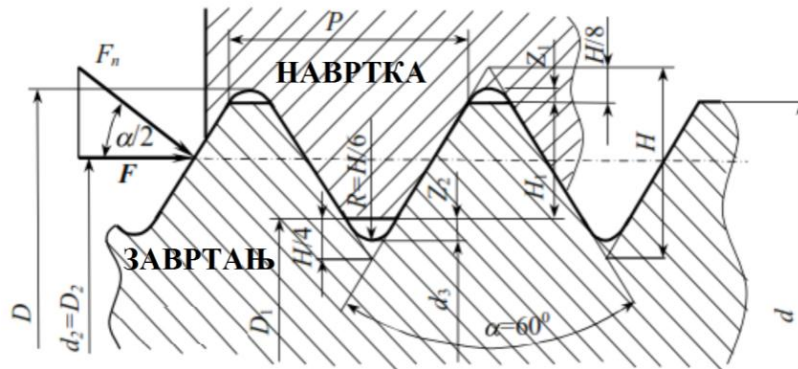
Слика 3.2. Метрички навој – облик профила у навојном пару са димензијама [14]
