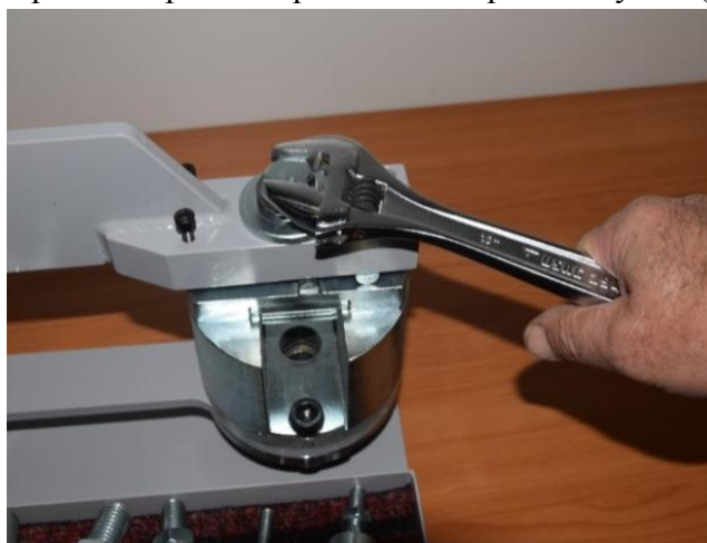
Слика 4.8. Притезање завртња кључем
