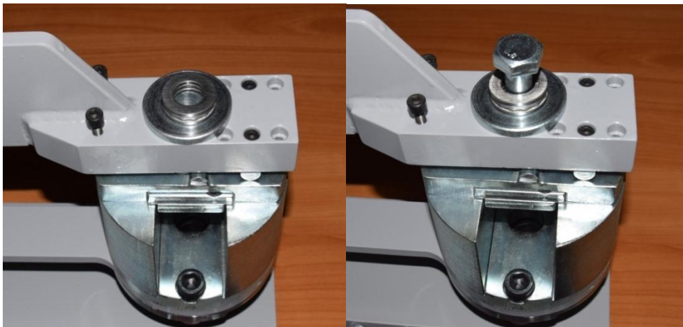
Слика 4.7. Постављање аксијалног лежаја и одговарајућег завртња
