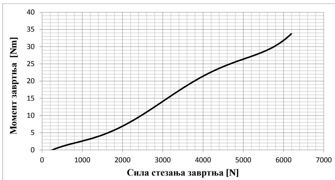
Слика 4.19. Зависност момента завртња од силе стезања завртња М18
