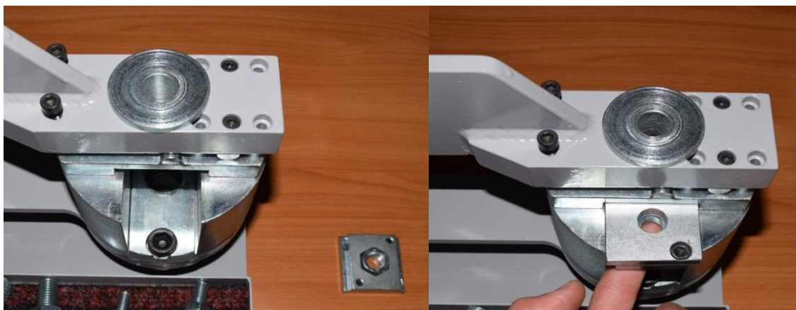
Слика 4.6. Постављање чауре и изменљивог носача навртке
