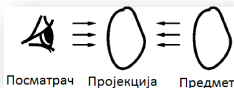
Слика 13 – Положај предмета, пројекције и посматрача (цртача) код америчког распореда пројекција [1]
