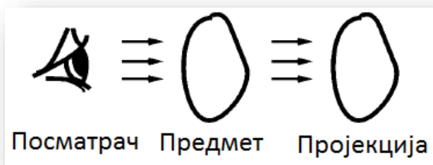
Слика 9 – Положај предмета, пројекције и посматрача (цртача) код европског распореда пројекција [1]
